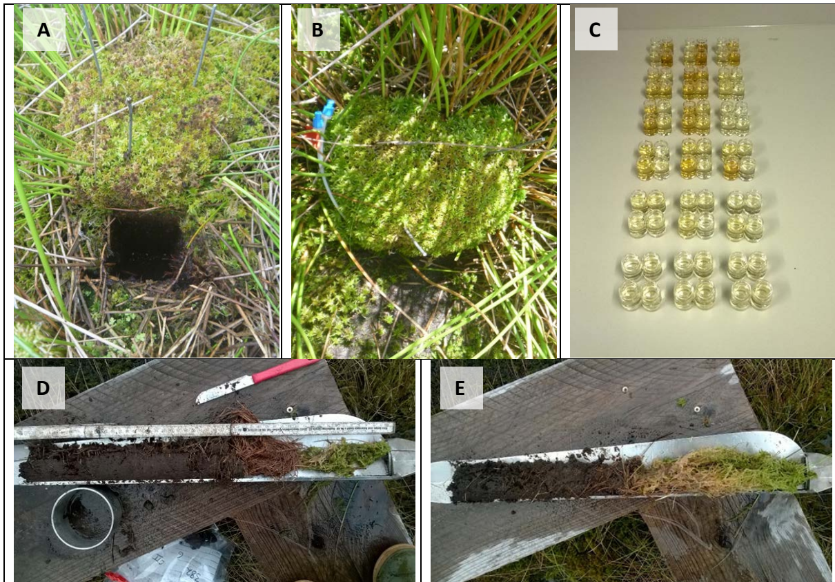
Abb. 3-9. Arbeitsschritte zur biogeochemischen Charakterisierung der Monitoringflächen. (A+B) Einrichtung von Porenwasser-Probennehmern am Beispiel der Flutterbinsen-Fläche-I (A3) für wasserchemische Analysen im Labor (C); und Beprobung von Torfkernen zur biogeochemischen Inventur der Versuchsflächen (D: Wollgras-Torfmoos-Schwingrasen-I [A1]; E: Wollgras-Torfmoos-Schwingrasen-II [A2])
