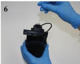
Sie die Küvette und den entsprechenden Filter in das Smartphone-Photometer ein (3, 4). Starten Sie die Messung am Smartphone-Photometer. Hierfür müssen Sie die App „*Physics Toolbox Sensor Suite*“ starten. Die Bedienung der App ist im Kapitel Benutzung der App „*Physics Toolbox Sensor Suite*“ (Seite 9) erläutert. Der erste Messwert jeder Probe dient als Startwert der Reaktion.
