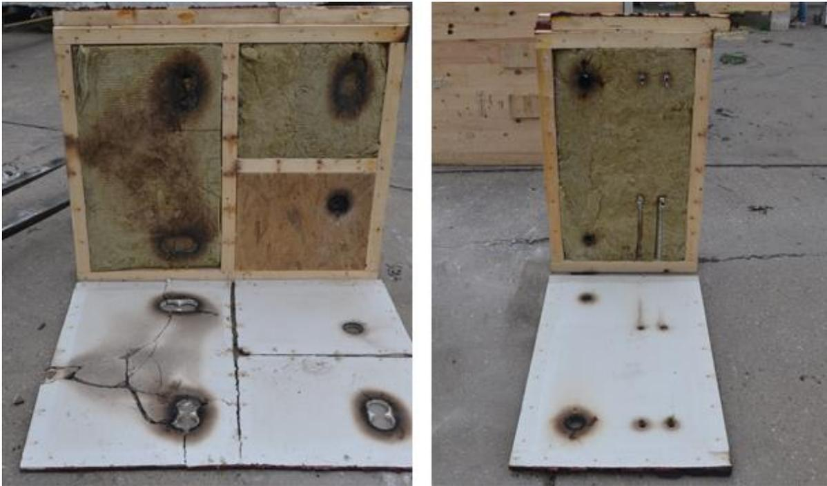
Abbildung 42: Brandbeanspruchung im Bereich der Elektrodoesen hinter der Kapselbekleidung in Holztafelbauelementen [19]
