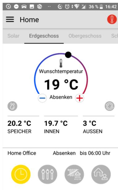
Abb. 5.2 Layout „Home“: Heizungssteuerung
