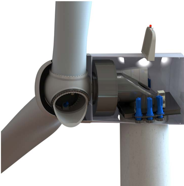
Abbildung 41: Ansicht Generator Typ Upwind – Einbauort zwischen Blättern und dem Turm, hier mit Haupt-Momentenlagerung.
