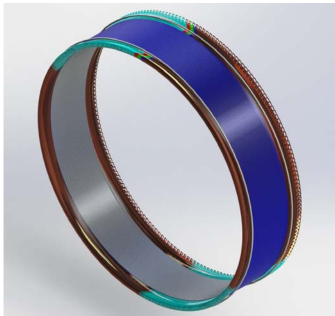
Abbildung 163: Gerenderte 3D CAD Darstellung der Statorspulen mit eingefärbtem Spulensektor der die verschiedenen Lage der drei Statorsysteme verdeutlicht.
