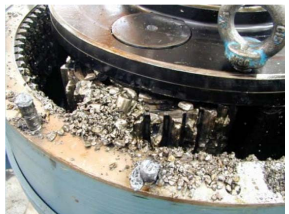
Abbildung 2: Getriebeschaden an einer Windturbinen-Nabe. Quelle: Allianz Zentrum für Technik
