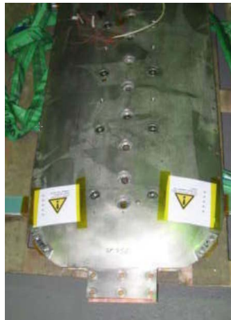
2009: Testspule für 500 kW, 30 rpm Windkraft-generator. Rolle ECO 5-Team: Design und Fertigung der HTS-Spulen.
