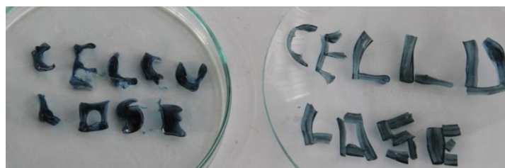
Abbildung 19: Mit Indigo-Farbstoff angefärbte Cellulosefäden.
