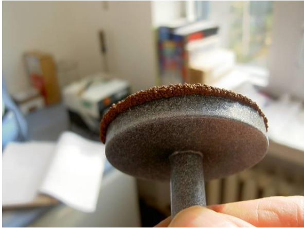
Abbildung 2: Probe aus St-37.2 als Kathode
