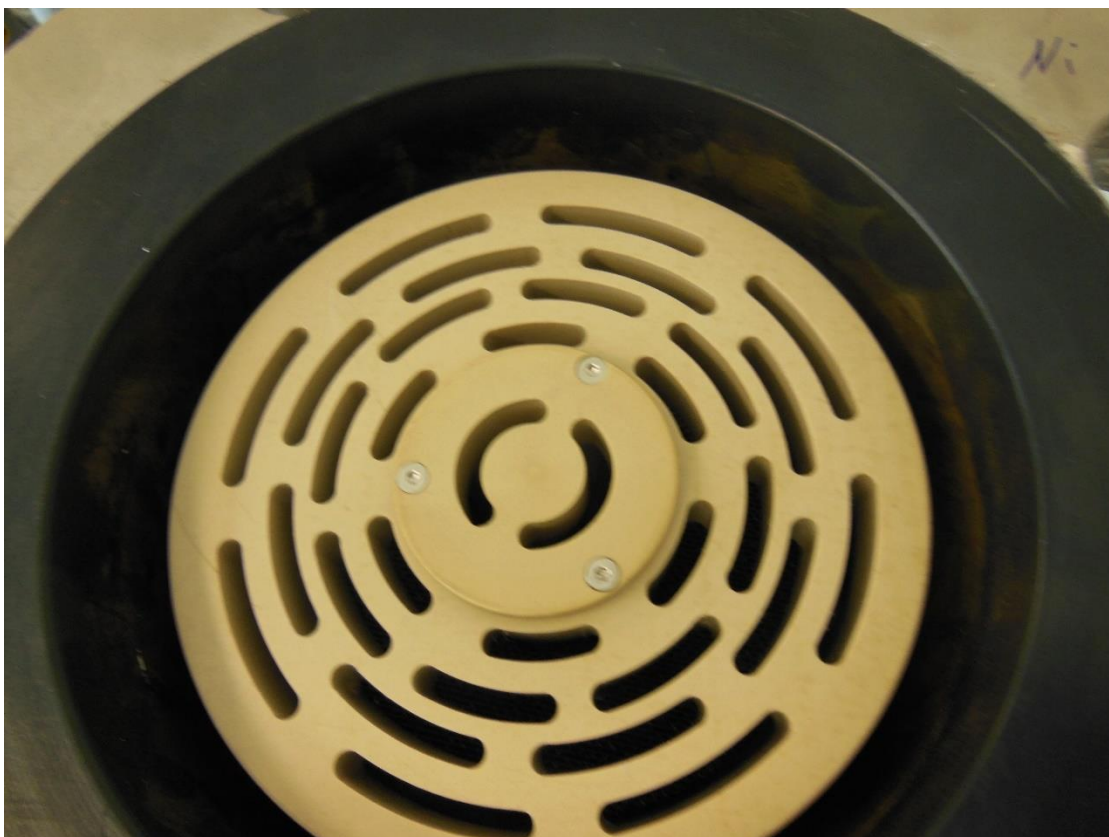
Abbildung 27: Abscheider in Einbaulage in der Messkammer
