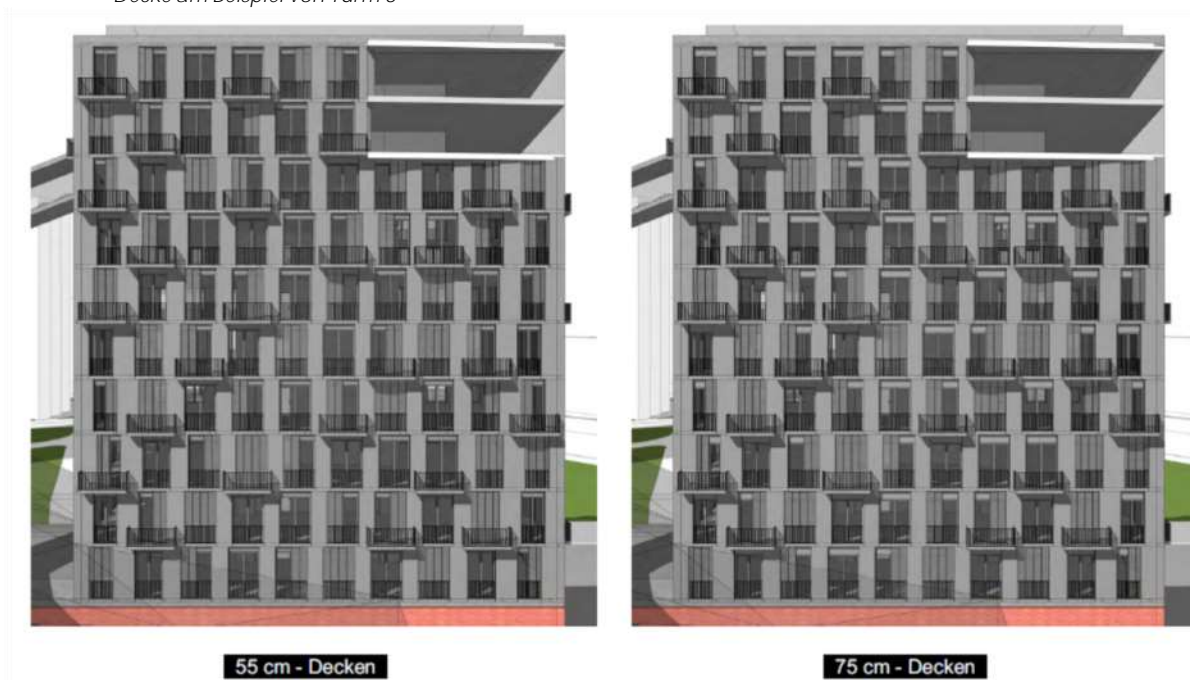
Abb 10: Auswirkungen der Konstruktionsvarianten Variante 1 gegenüber Variante 3; Vergleich 55 cm Decke und 75 cm Decke am Beispiel von Turm 3
