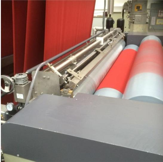
6.1: rote Fasern und Flusen als Ablagerung auf den Foulardwalzen
