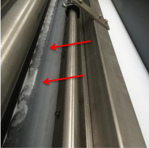
7.1: Schaumbildung im Zwickel und Bildung von Flusennestern im Zwickel zwischen Raster- und Gummiwalze (rote Pfeile)
