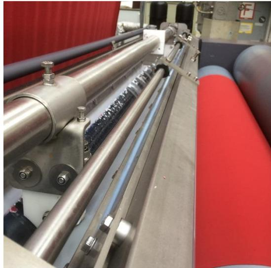
6.2: ungleichmäßiger Rückfluss der Flotte von der welligen Rakel der Gummiwalze
