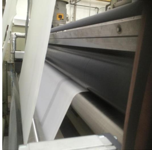
7.2: Streifenbildung in Längsrichtung der Warenbahn aufgrund der Welligkeit der an der Rasterwalze anliegenden Rakel
