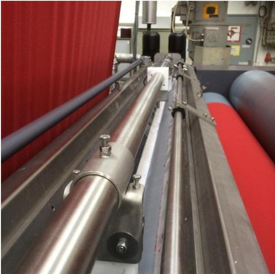
6.3: rote Fasern und Flusen als Ablagerung an der Rakel der Rasterwalze
