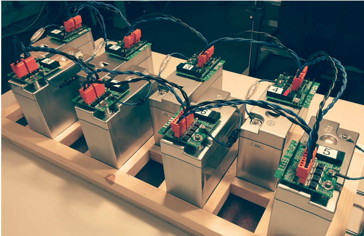
Abbildung 24: Laboraufbau des Batteriespeichers
