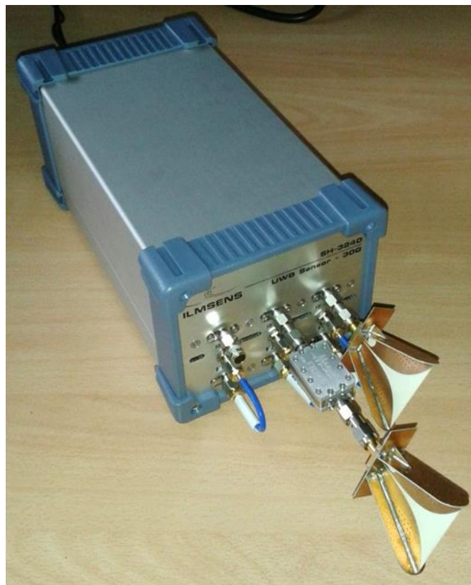
Abb. 23: 30-GHz Prototyp mit zwei Antennen
