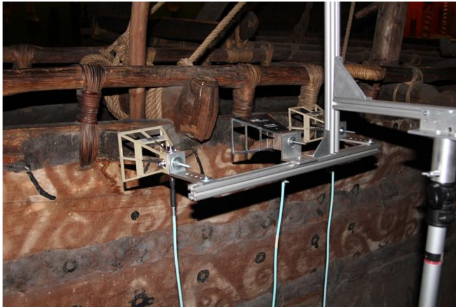
Abb. 18: Messaufbau am Ethnologischen Museum in Berlin. Die mittlere Antenne bildet den Sendekanal, links und rechts davon sind die beiden Empfangskanäle.
