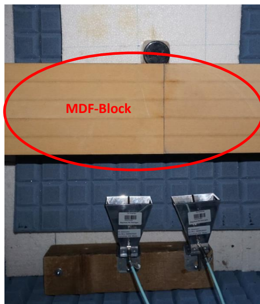
Abb. 15: Messaufbau zur Detektion einer Schädlingskolonie ( Tribolium confusum ) mit eingebrachtem Hindernis (zweiteiliger MDF-Block)
