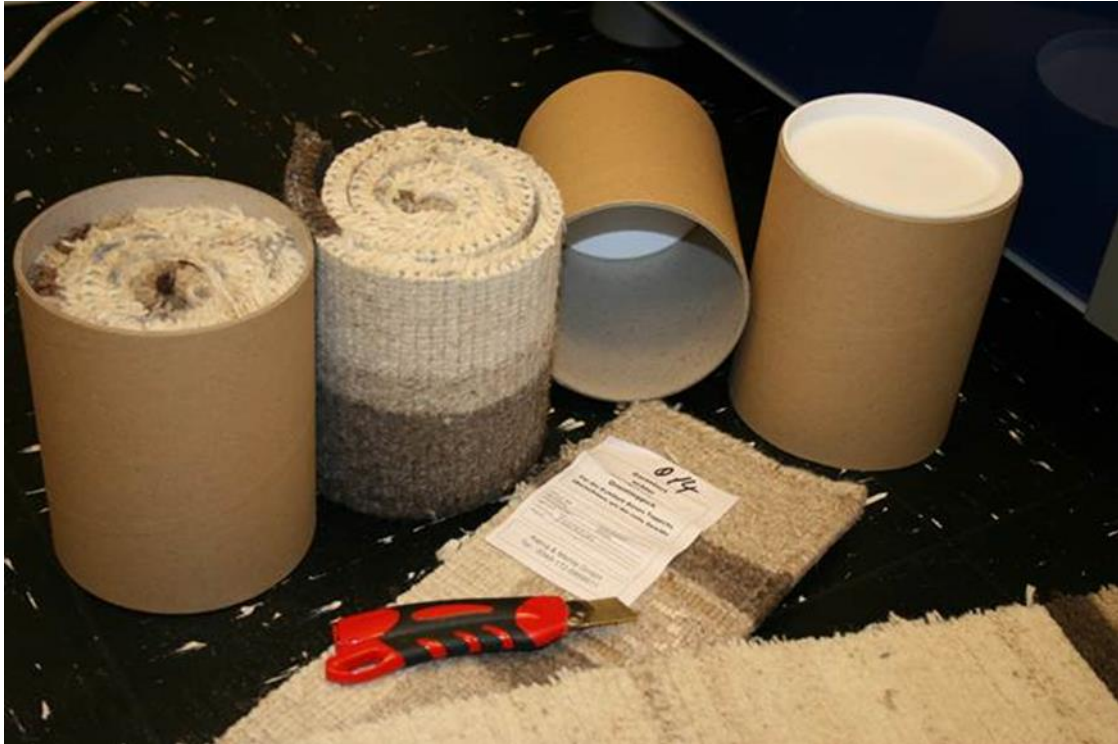
Abb. 3: Konstruktion von Probenkörpern. Gezeigt sind erste Probenkörper. Hierzu wurden Papprollen von 20 cm Höhe, 15 cm Durchmesser und 4 mm Wandstärke mit aufgerollten, passenden Stücken eines Wollteppichs versehen. Die entsprechenden Probenkörper wurden anschließend zur BAM gebracht und dort mit Eiern der Kleidermotte beimpft. Aktuell werden diese Proben bebrütet, um ein museales Objekt mit starken, andauernden Kleidermottenbefall zu simulieren.
