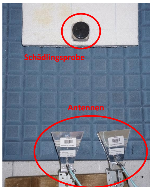
Abb. 14: Messaufbau zur Detektion einer Schädlingskolonie ( Tribolium confusum ) mit direkter Ausleuchtung ohne Hindernis
