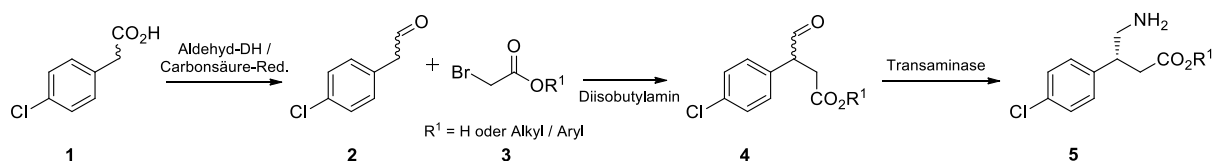
Abbildung 1 Chemo-Enzymatische Darstellung eines \beta -chiralen Amins am Beispiel von Baclofen.
