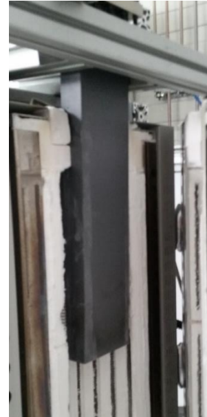
Abbildung 11 Dichtungskonzept des Hochtemperaturmikroreaktors (links; (1) Anschluss Mikroreaktor mit Ein- und Auslass des Prozessgases, (2) Gegenflansch, (3) Hochtemperaturdichtungen, (4) SiC-Mikroreaktor), verbauter Mikroreaktor (rechts).
