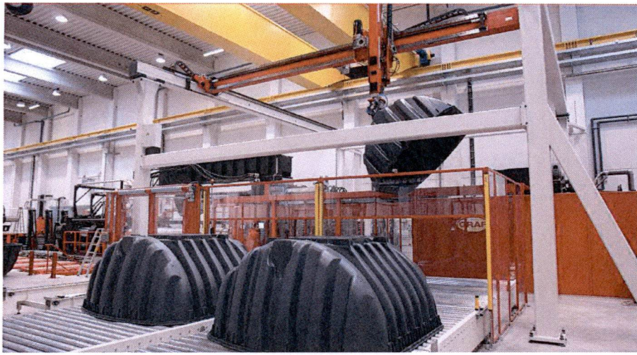
Abb. 5: In Projektphase 2 für Schussgewichte bis 150 kg entwicklungs-technisch umzurüstende Spritzgussanlage
