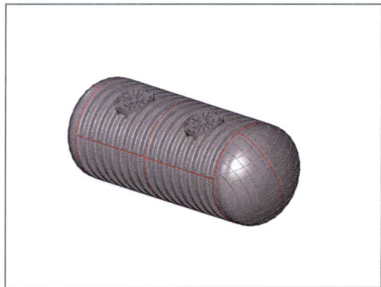
Abb. 13: Neues Jumbo-Großtanksystem, gefertigt aus 3 Halbschalen, zusammengesweißt
