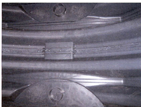
Abb. 1: Abdichtungsprofil in der Entwicklung (hier Schweißung), horizontaler Verlauf der Abdichtung (links), vertikaler Verlauf der Abdichtung (rechts)
