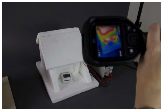
Abbildung 8: Dach Styroporhaus mit Wärmebildkamera
