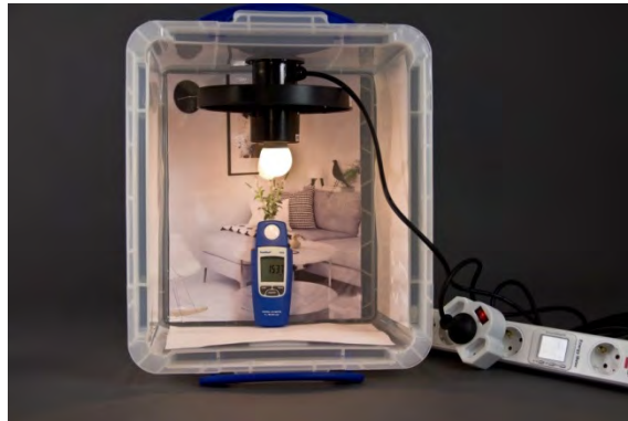
Abbildung 42 Versuchsaufbau Wirkungsgrad von Lampen
