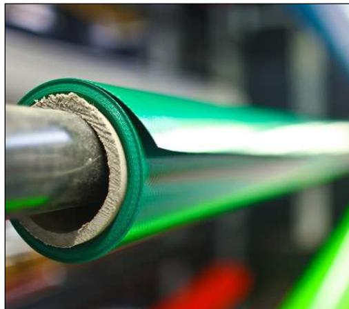
Abb. 20: PVC beschichtetes PES Gewebe mit einer Festigkeit von mindestens 3800/3800 N auf 5 cm
