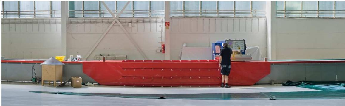
Abb. 24: Hochfrequenzschweißen der Innenkonstruktion der Außenhülle der trapezförmigen Behälterkonstruktion mit Haltetaschen für Karabinerhaken (Trapezbehälter Baureihe I)
