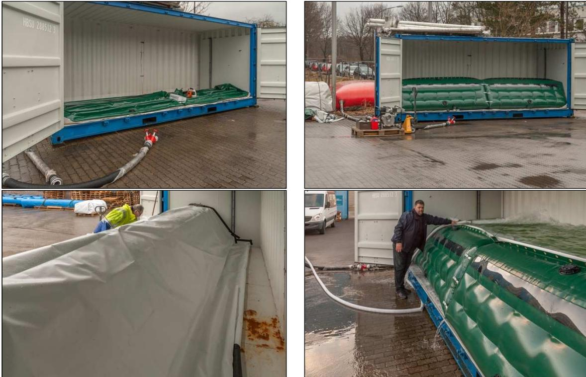
Abb. 32: Labormodell Trapezbehälter Baureihe II mit wasserseitiger Plane und Dränmatte im Testcontainer
