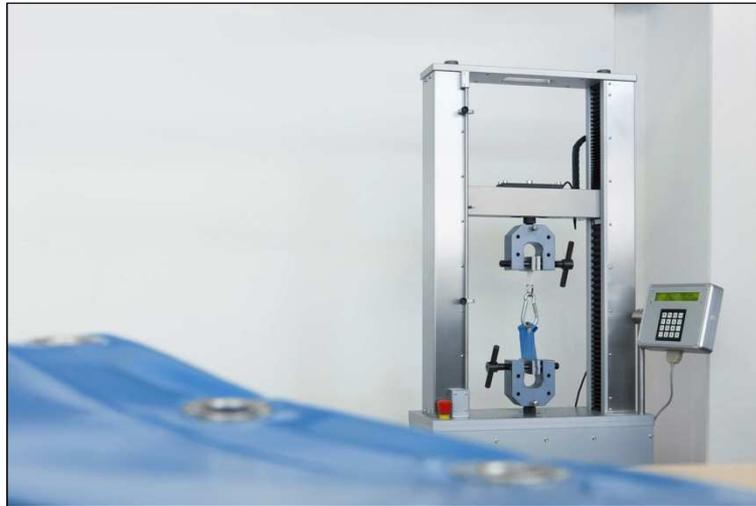
Abb. 15: Zugzustand zum Testen der Schweißnähte und des zu verarbeiteten Materials
