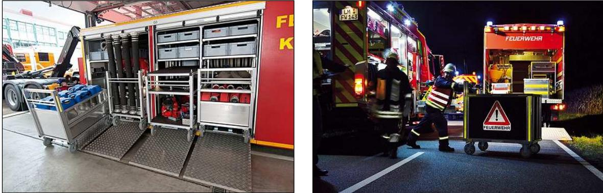
Abb. 35: Verpackung in Form von fahrbaren Kleinrollcontainern und multifunktionalen Logistikfahrzeugen im Euro-Maß
