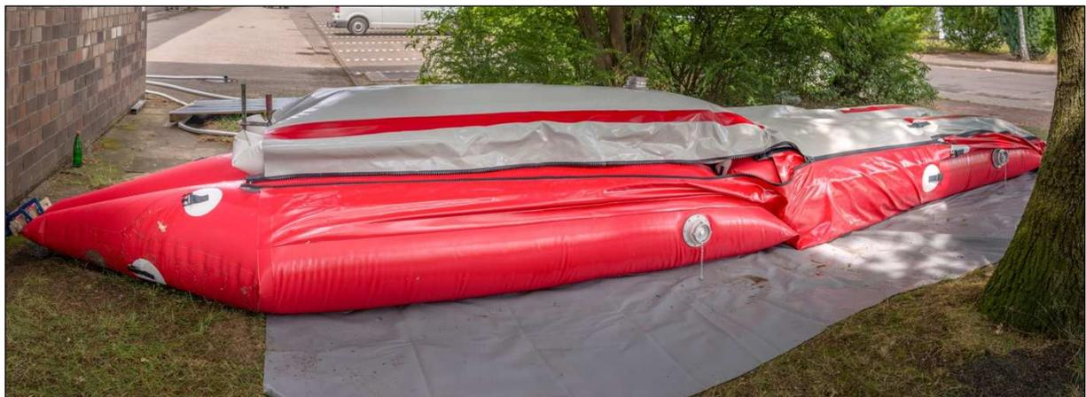
Abb. 29: Labormodell Doppelkammerschlauch teildurchlässiger Mittelnahat mit aufgelegtem dritten Schlauch
