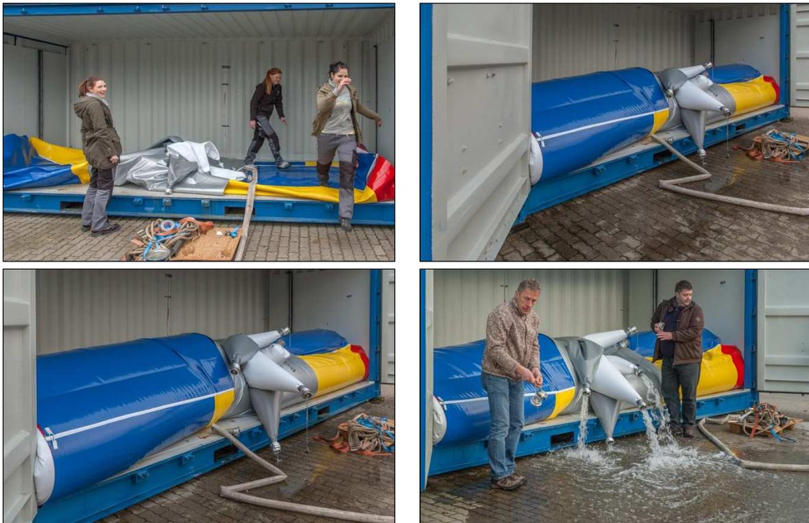
Abb. 28: Test zweier aus drei Schläuchen mit Befülltuben bestehender Segmente im Testcontainer, Betriebshof DAEDLER
