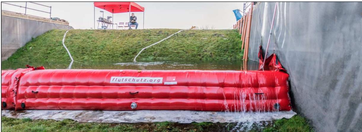
Abb. 36: Aufbau und Volleinstau mit Überlauf der Prototypen bei der TÜV-Zertifizierung
