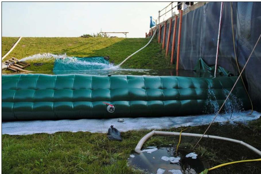
Abb. 34: Einstautest mit teilweiser Wasser- und Luftfüllung im IWA-Testbecken
