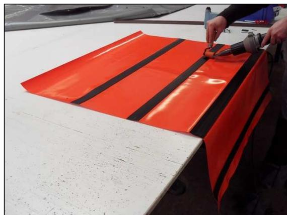
Abb. 16: Materialtest zur Haftfestigkeit und Abrasion auf Untergründen, Tests von Ertüchtigungen zur Bodenhaftung
