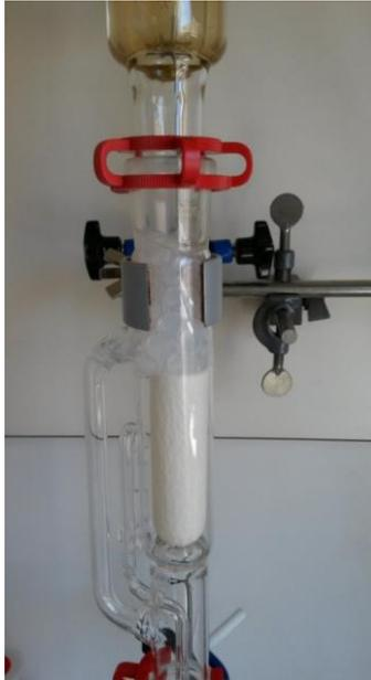
Das hier eingesetzte Kunststoffgranulat (LLD-PE ATTANE SL 4100G natur der Fa. UNIWELL Rohrsysteme GmbH & Co. KG) quillt durch das Lösungsmittel im ersten Versuch auf und tritt aus der Extraktionshülse aus.
