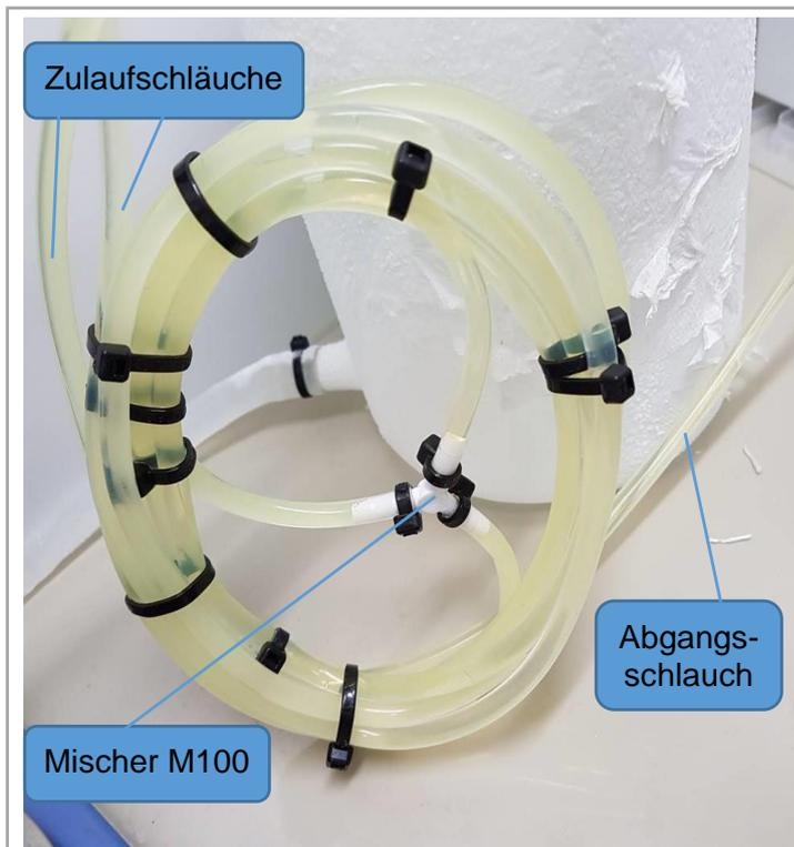
Abb. 32: Schlauchreaktor mit Y-Mischer befüllt mit Reaktionsgemisch
