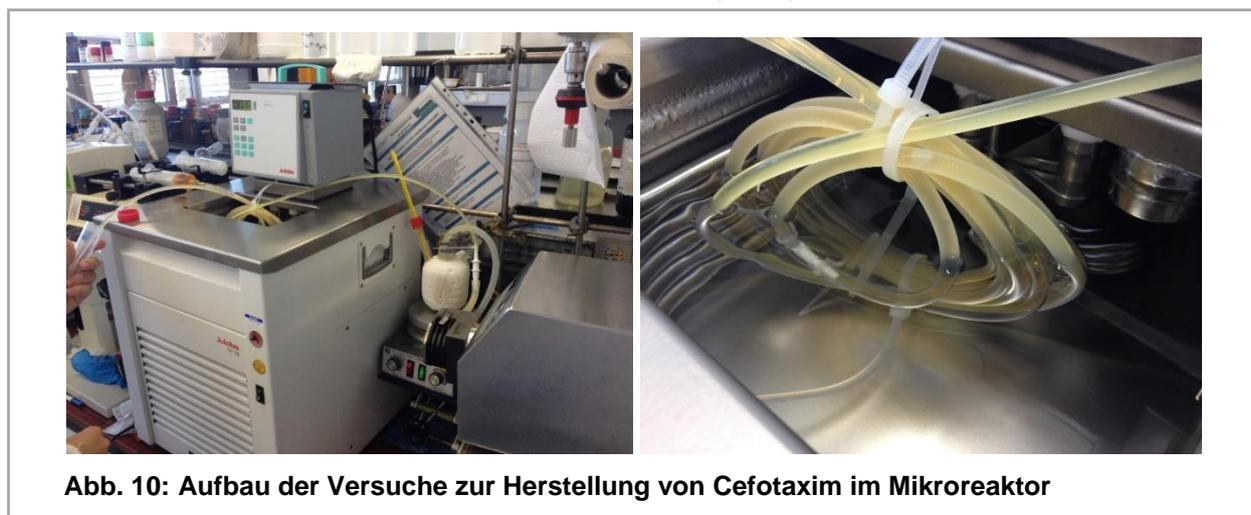
**Abb. 10: Aufbau der Versuche zur Herstellung von Cefotaxim im Mikroreaktor**
