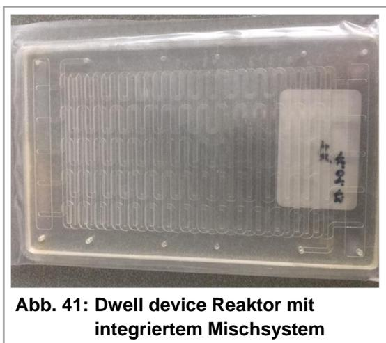
**Abb. 41: Dwell device Reaktor mit integriertem Mischsystem**
