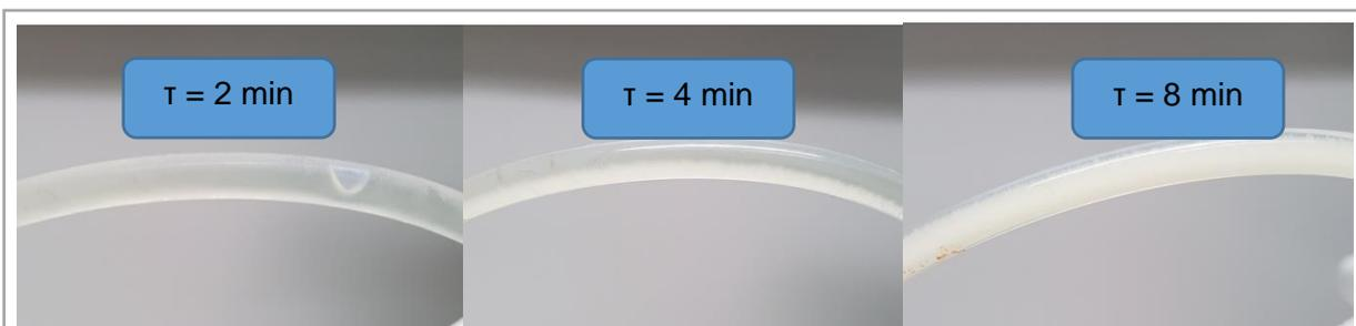
Abb. 33: Sedimentationseffekte bei unterschiedlichen Verweilzeiten
