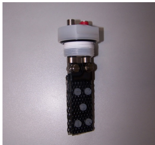
Abbildung 7: Elektrodenstack mit zwei funktionalen Einheiten in paralleler Verschaltung
