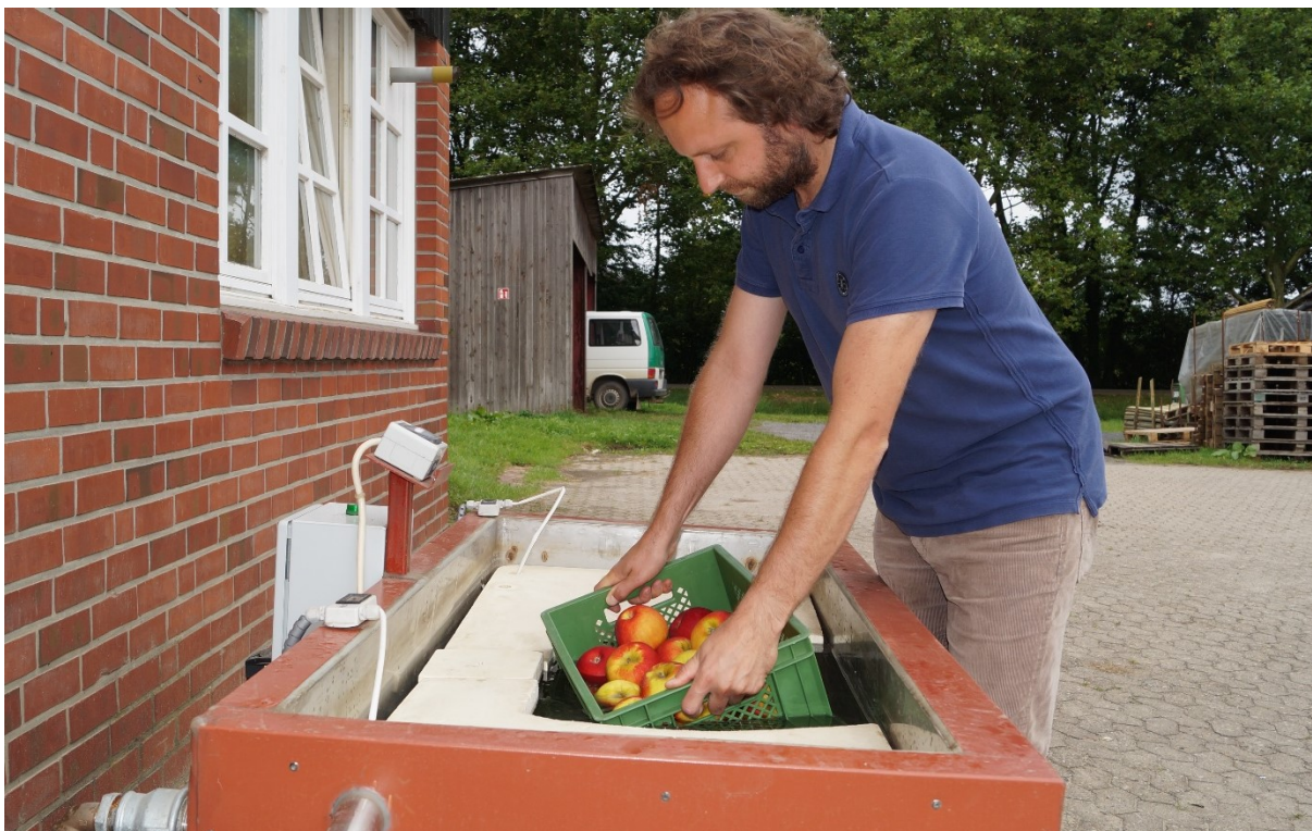
Abb. 7 Konventionelles Heißwassertauchen (HWD) bei 50 \text{ °C} für 180 Sekunden. Hier exemplarisch durchgeführt im Kleinkistenverfahren an isolierter und beheizbarer 325 l Tauchwanne. (Foto: Appel, 2017)
