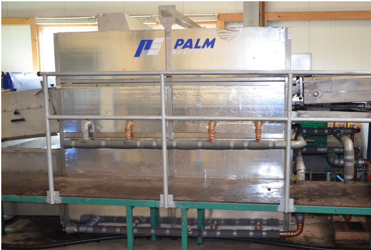
Abb. 6 Neuentwicklung HWR-Gerät der Firma Palm Systems, Hamburg. Installation auf dem ökologisch wirtschaftenden Obstbaubetrieb / Obsthandelsbetrieb Obsthof zum Felde, Jork. Fruchtdurchsatz der Maschine im HWR-Betrieb liegt bei mindestens 10 \text{ t h}^{-1} . (Foto: Holthusen, 2016)
