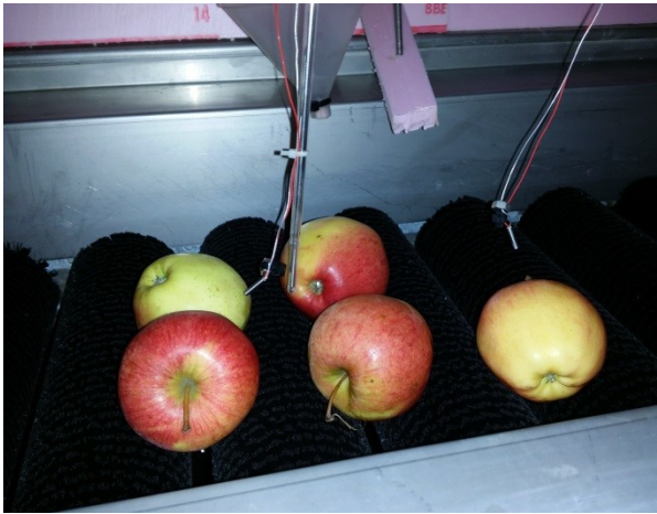
Abb. 3 Überwachung der Behandlungstemperatur im Duschaum mit PT 100-Thermometer und zusätzlichen Digital-Thermometern. (Foto: Holthusen, 2014)
