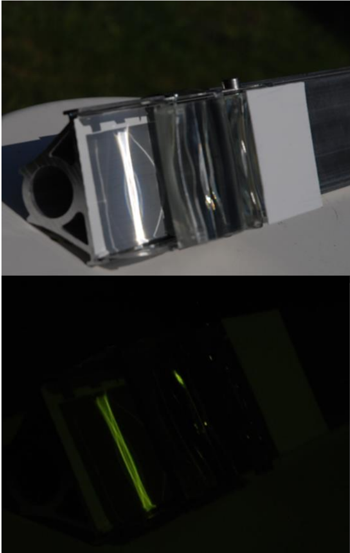
Abb. 17: Fotos des Zellasemblies mit Linse bei einer Sonne, einmal bei normaler Belichtung und einmal mit Filter bestehend aus Schweißerglas
