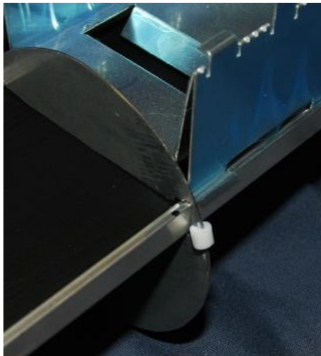
Abb. 30: Foto des Abstandshalters in Form einer Kreisscheibe (am linken Bildrand) mit einem der drei Teflon-Gleiter (Mitte) auf dem Wärmeträger-Rohr
