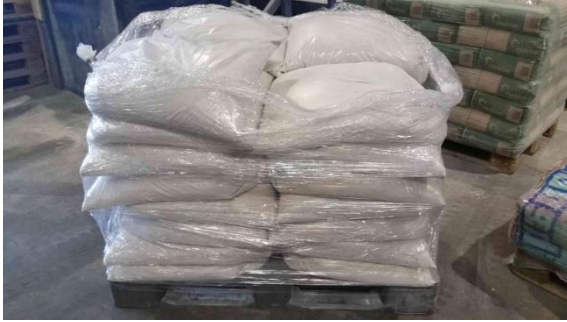
Anhang 4.1: Porenbetonrezyklat, getrocknet, dosiert und verpackt
