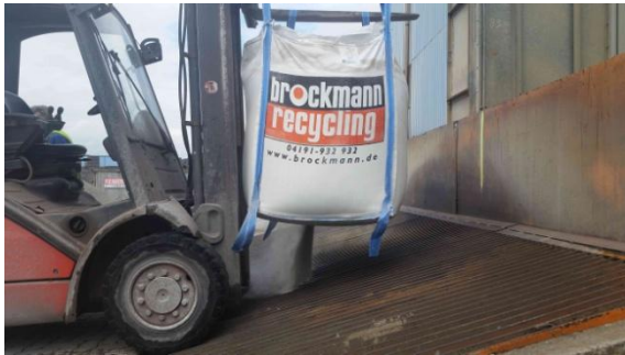
Anhang 3.1: Einbringen des Porenbetonrezyklats in die Einlaufmulde
