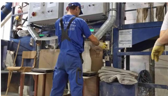
Anhang 4.5: Füllen der Säcke mit Trockenmörtel
