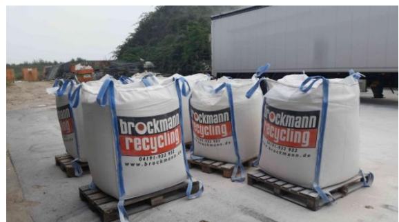
Anhang 1.6: In Big Bags gefülltes Porenbetonrecycling
