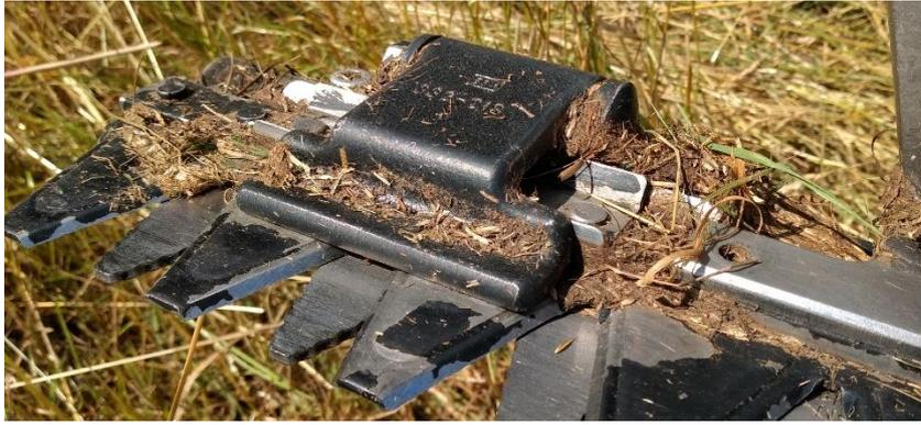
**Abbildung 4.36: Messerlagerung nach einem Mäheinsatz**
