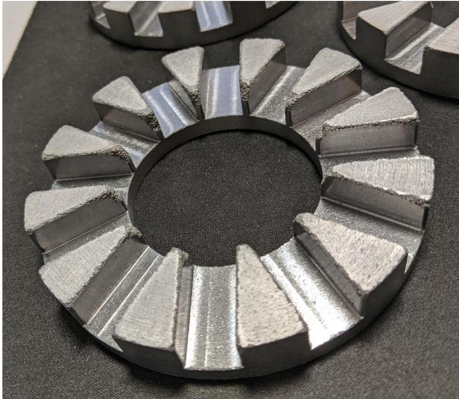
**Abbildung 3.31: SMC Prototypenmaterial mechanisch bearbeitet**
