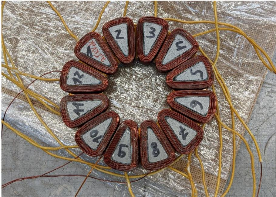
**Abbildung 3.29: Stator mit eingelegten Spulen**
