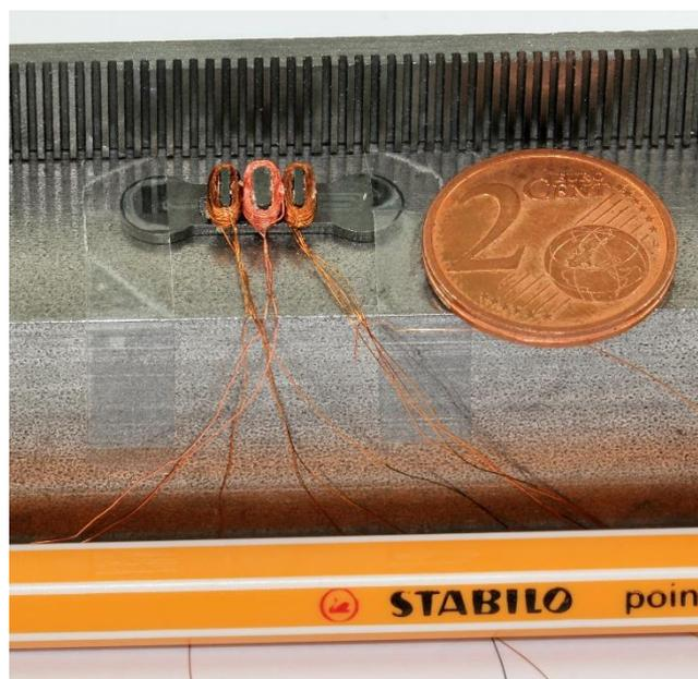
**Abbildung 4.16: Ferritbauelemente für einen inkrementellen Positionssensor**
