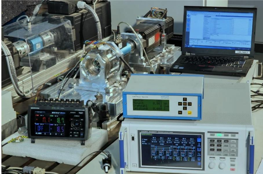
**Abbildung 3.52: Messaufbau für die Wirkungsgradbestimmung**
