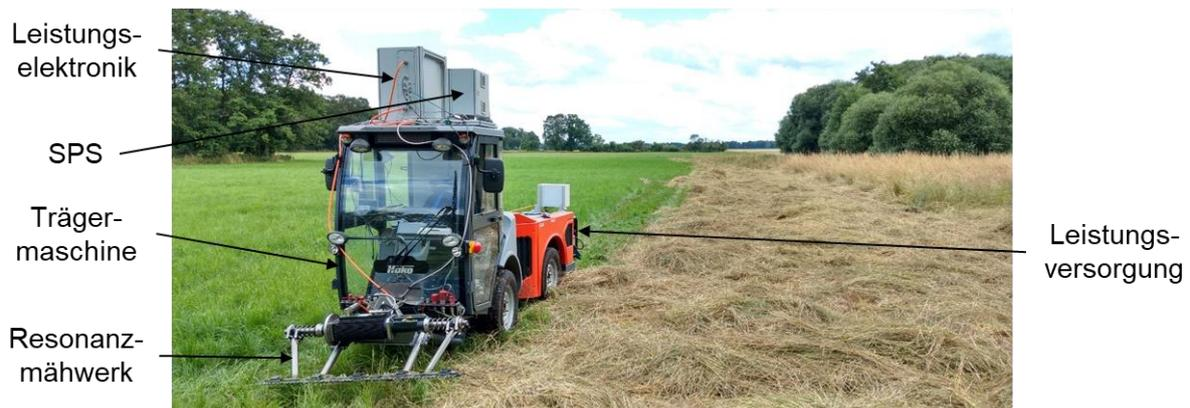
**Abbildung 4.28: Aufbau für Feldversuche mit Resonanzmähwerk**
