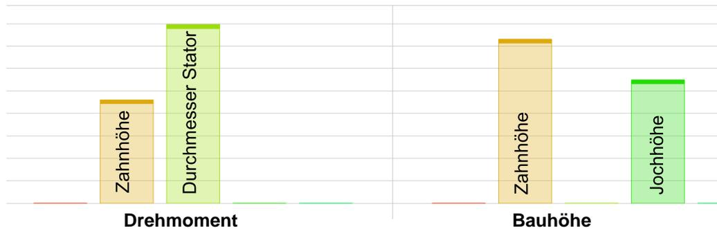
**Abbildung 3.13: Ergebnis Empfindlichkeitsanalyse für Drehmoment und Bauhöhe**
