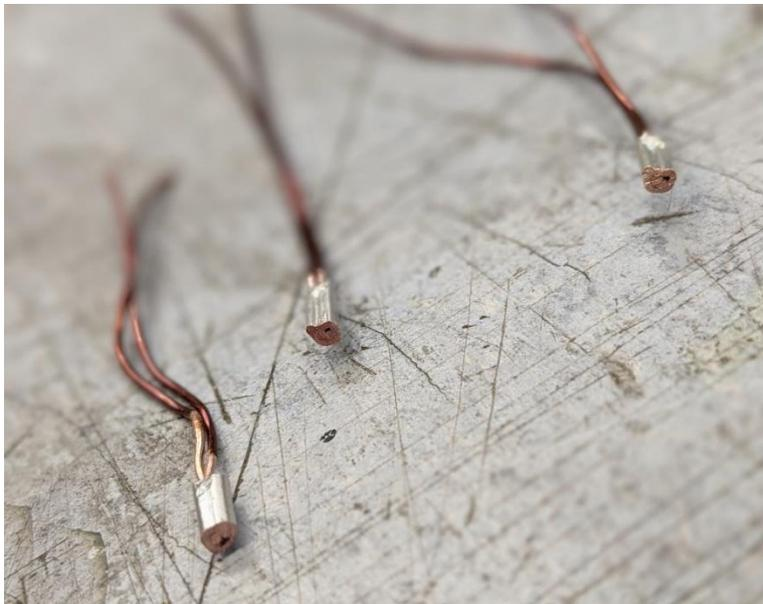
**Abbildung 3.30: Quetschversuche – Prüfung auf Festigkeit und Qualität der Verbindung**
