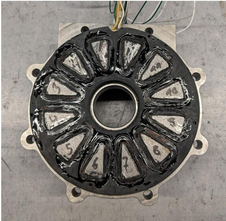
**Abbildung 3.33: Statorhälfte vergossen – bereit zur Montage**
