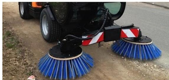
**Abbildung 3.4: Alternative Besenverstellungen: links Seilzug, rechts Teleskop**
