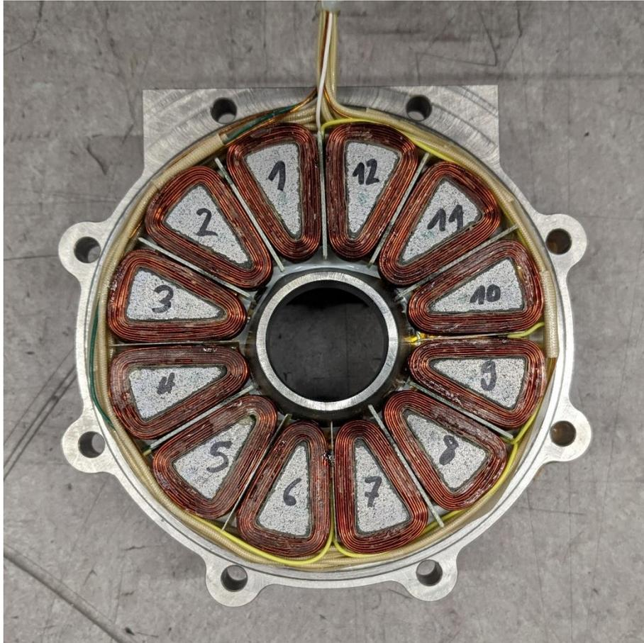
**Abbildung 3.32: Statorhälfte bereit zum Vergießen**
