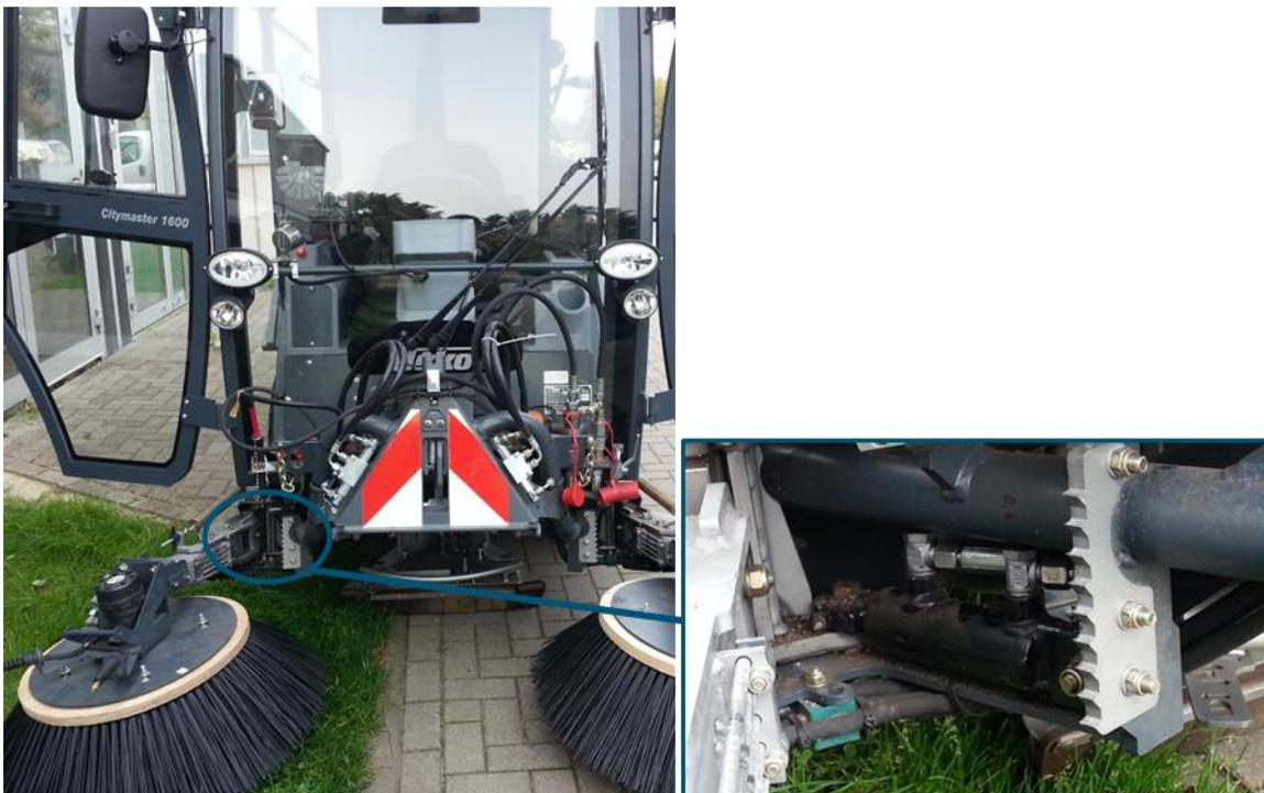
**Abbildung 3.1: Frontansicht der Beispielmachine mit Kehraggregat und Detailansicht des Stellzylinders**
