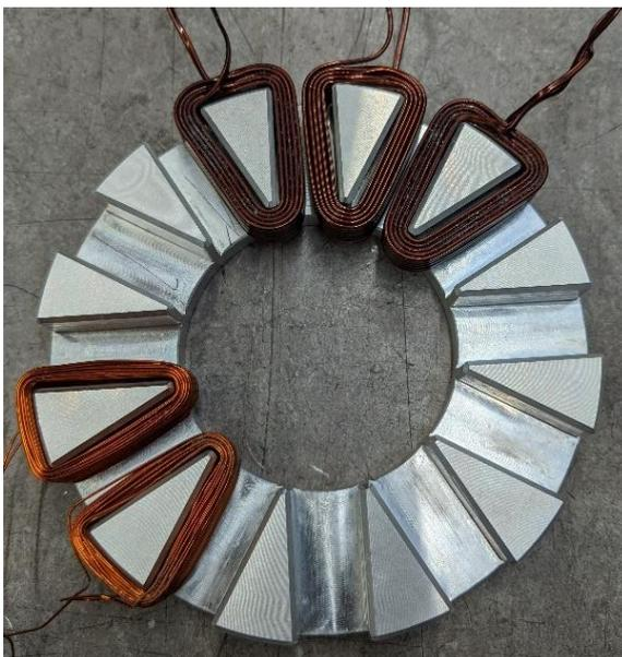
**Abbildung 3.27: Statordummy mit verschiedenen Spulenvarianten**
