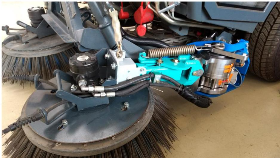
**Abbildung 3.62: Funktionsprüfstand der elektromechanischen Seitenbesenverstellung in Einbaulage am Trägerfahrzeug**
