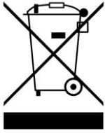
Abb. 1 Symbol zur Gerätezeichnung gemäß ElektroG – Kennzeichnung für Geräte, die nach dem 13.05.2008 in Verkehr gebracht wurden
