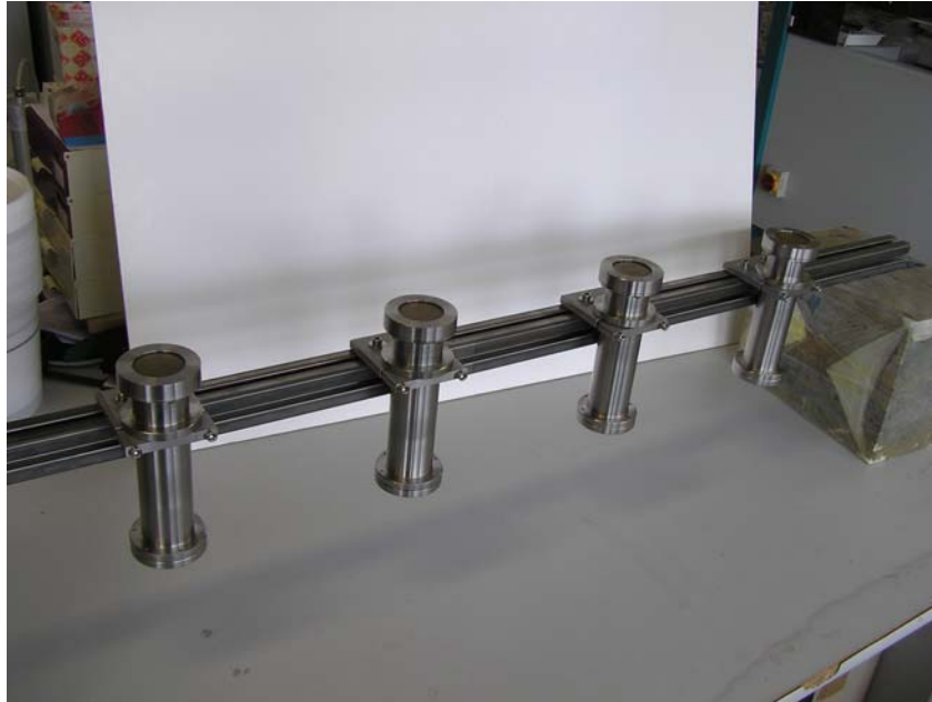
Abb. 14 Prototyp eines Zeilenscanners aus Einzelsensoren für den Einsatz an einem Bandtrockner
