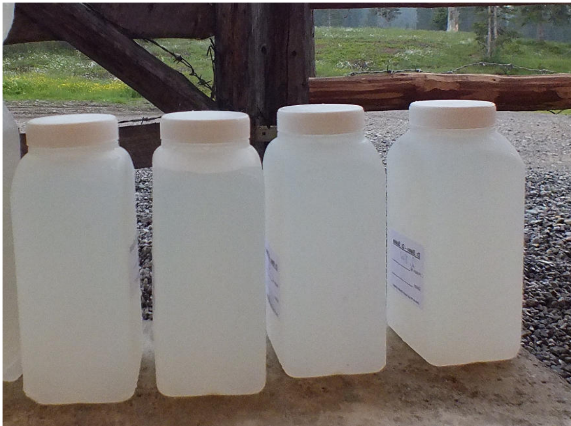
Abb. 17 Optische und gemessene Trübung (NTU) bei fortgesetzter Rückspülung mit ozonhaltigem Reinwasser
