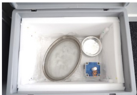
Abb. 139 Konditionierung der Euronormbox mit Salzlösungen
