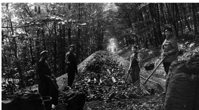
Abb. 41 Köhlerei: Historisches Foto des frühen 20. Jahrhunderts mit nach alter Tradition betriebenen Holzkohlenmeiler im Solling bei Delliehausen
