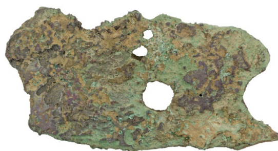
Abb. 53 Romanische Glashütte S-NW3. Für die Einfärbung der Gläser verwendetes metallisches Rohmaterial. Schwärzlich, rot und grün oxidiertes 57,2 g schweres Rohkupfer
