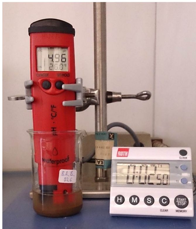
Abb. 105 Bestimmung des pH-Wertes nach DIN 19684 im Labor der Otto-Friedrich-Universität Bamberg
