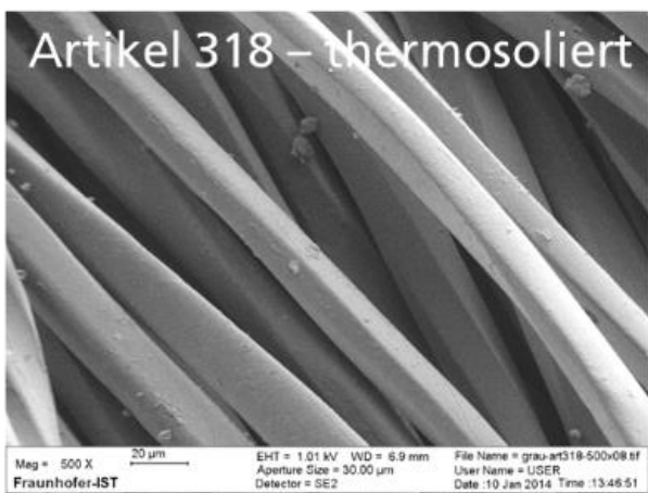
Abbildung 2: REM-Aufnahmen von verschiedenen Flammschutztextilien.
