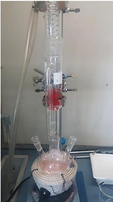
Abbildung 6: Aufbau der Soxhlet-Extraktion
