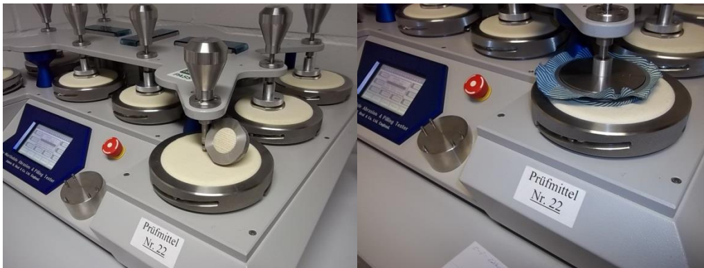
Abbildung 8: Prüfapparatur zur Bestimmung der Scheuerbeständigkeit von textilen Flächengebilden.
