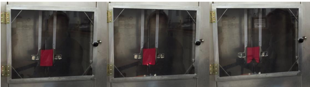
Abbildung 11: Start bis Ende der Brandprüfung am unbeschichteten Textil (oben: von links bis rechts) und am beschichteten Textil (unten: von links nach rechts.)
