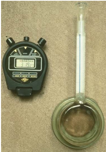
Abbildung 1: Prinzip der Wasseraufnahmemessung nach Karsten mit Auswerteverfahren zur Berechnung des kapillaren Wasseraufnahmekoeffizienten w [7].
