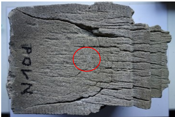
Abbildung 7: Wassertropfeneindringzeit (blau) und Kontaktrandwinkel im Querbruch (Bohrkernentnahme an roter Markierung). Gealterte Hydrophobierung (Schilfsandstein, Kirche Neuenstein).
