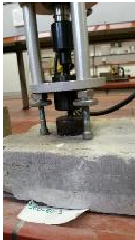
Abb. 2: Haftzugprüfung an Probe DBU-BW-3
