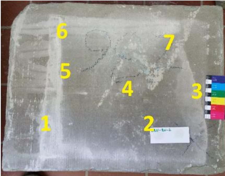
Abb. 3: Ansicht der Probe DBU-BW 2 mit eingezeichneten Bohrmessstellen 2-1 bis 2-7. Leichtes Abschalen an den äußeren Seitenkanten. Unterschiedliche Farbvarietäten erkennbar.
