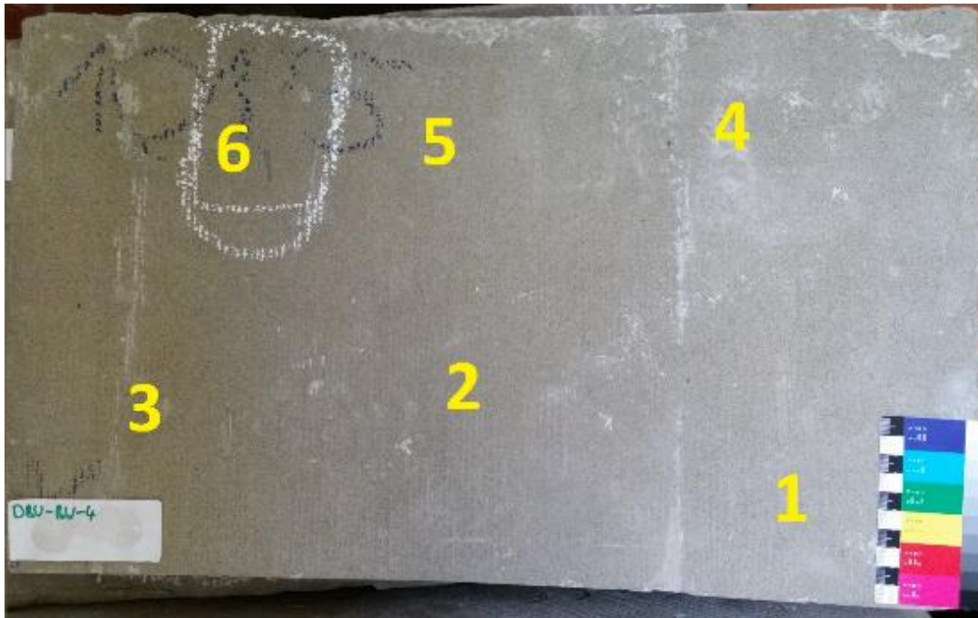
Abb. 7: Ansicht der Probe DBU-BW 4 mit eingezeichneten Bohrmessstellen 4-1 bis 4-6. Sehr homogene Oberfläche. Der Bereich mit Resthydrophobierung ist weiß markiert (Messstelle 6 in diesem Bereich).
