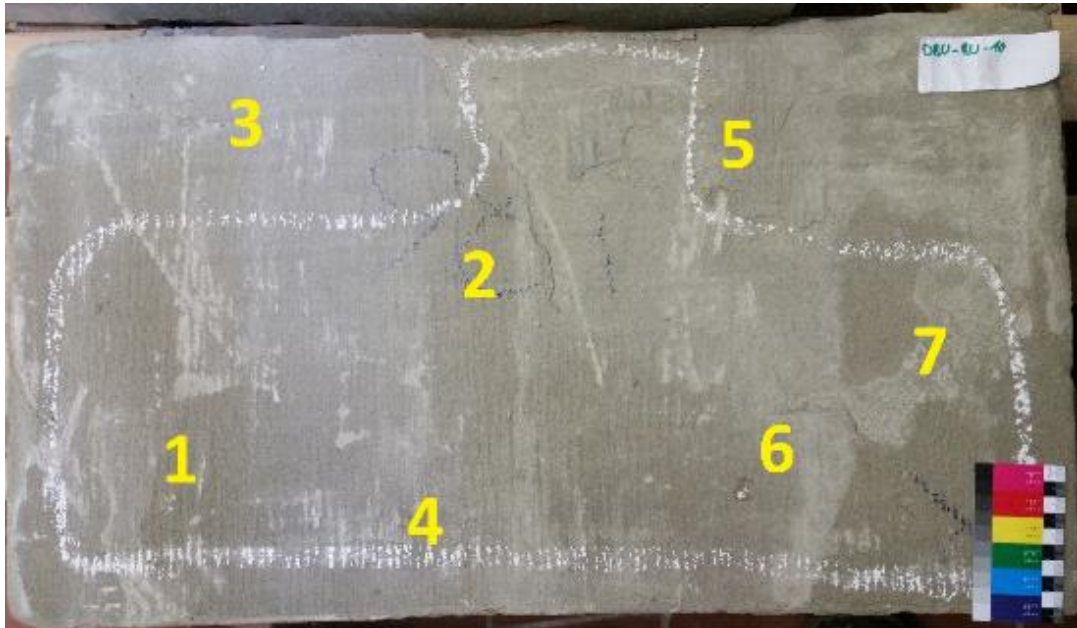
Abb. 19: Ansicht der Probe DBU-BW 10 mit eingezeichneten Bohrmessstellen 10-1 bis 10-7. . Homogene Oberfläche. Der Bereich mit Resthydrophobierung ist weiß markiert (Innenbereich).
