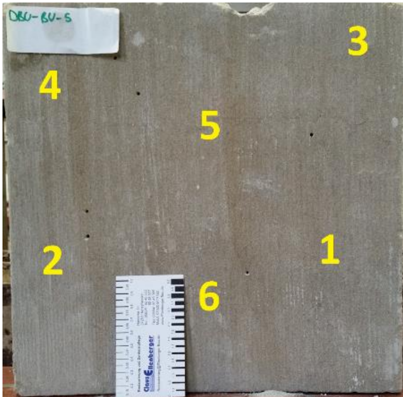
Abb. 9: Ansicht der Probe DBU-BW 5 mit eingezeichneten Bohrmessstellen 5-1 bis 5-6. Sehr homogene Oberfläche. Keine Resthydrophobierung vorhanden.
