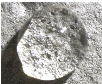
Abbildung 2: Prinzip der Messung der Wassertropfeneindringzeit und des zugehörigen Benetzungsrandwinkels [8, 9].
