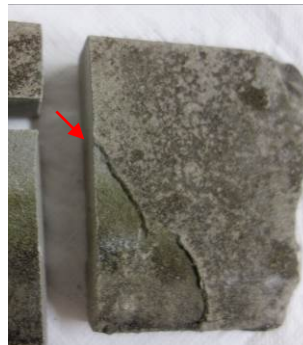
Abbildung 8: Wassertropfeneindringzeit (blau) und Kontaktrandwinkel im Querbruch (Trennschnitt an roter Markierung, Pfeil = Meßfläche). Gealterte Hydrophobierung (Molassesandstein, Altes Rathaus in Wangen).
