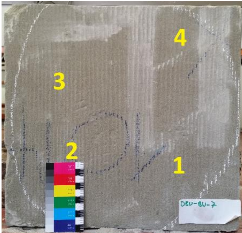
Abb. 13: Ansicht der Probe DBU-BW 7 mit eingezeichneten Bohrmessstellen 7-1 bis 7-4. Homogene Oberfläche. Der Bereich mit Resthydrophobierung ist weiß markiert (Innenbereich).
