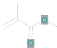
Abb. 4: Sandstein Neuenstein: MS-Identifizierung Peak 2,56 min als Methylmethacrylat
