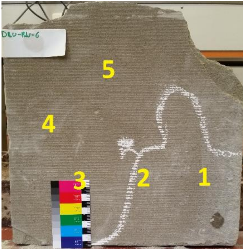
Abb. 11: Ansicht der Probe DBU-BW 6 mit eingezeichneten Bohrmessstellen 6-1 bis 6-5. Sehr homogene Oberfläche. Der Bereich mit Resthydrophobierung ist weiß markiert (linker Bereich).
