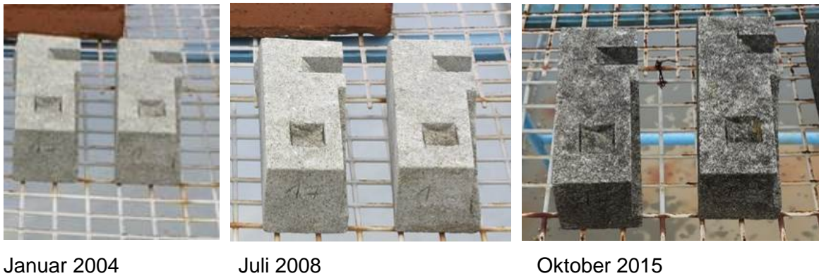
Abbildung 15: Proben 1.7 und 1.8, jeweils behandelt mit Funcosil SNL (Feb. 2003), nach unterschiedlich langer Exposition. Standort: München-Obermenzing, Expositionstisch auf dem Flachdach des Fachlabors Dr. Wendler.
