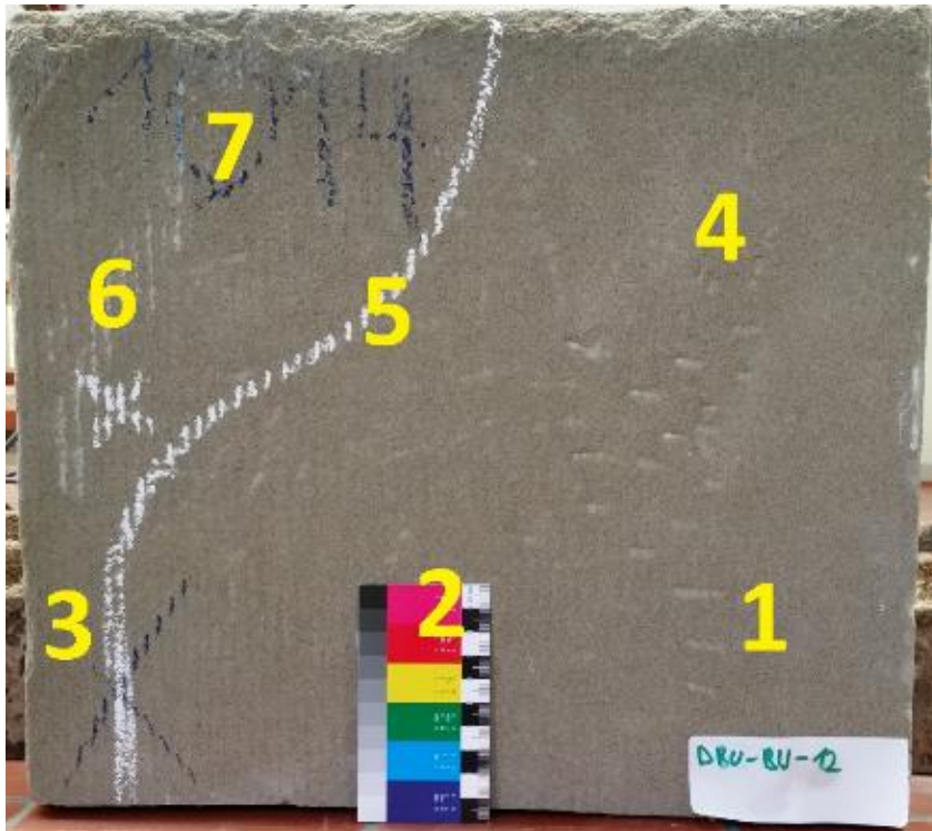
Abb. 23: Ansicht der Probe DBU-BW 12 mit eingezeichneten Bohrmessstellen 12-1 bis 12-7. . Homogene Oberfläche. Der Bereich mit Resthydrophobierung ist weiß markiert (Innenbereich links oben).
