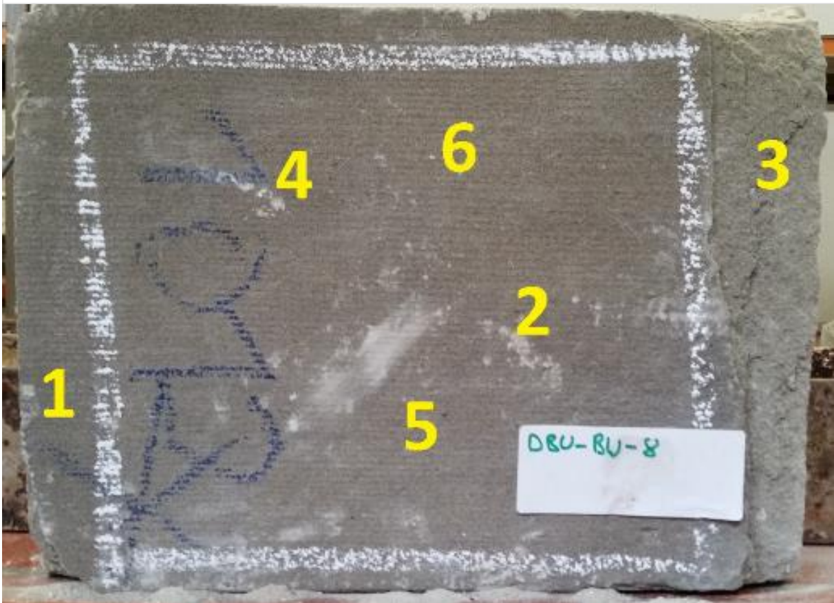
Abb. 11 Oben: Graphische Darstellung der Ergebnisse der Bohrwiderstandsmessungen an der Probenplatte DBU-BW 8 (unten) aus den Durchschnittswerten aller Bohrmessstellen. Das Profil ist typisch für eine Schalenbildung und eine Schwächung des Materials bis Bohrungsende (ca. 30 mm). Unten: Lage der Bohrwiderstandsmessungen 1-6, Verfahren Tersis 2 (Hersteller Geotron, Pirna).
