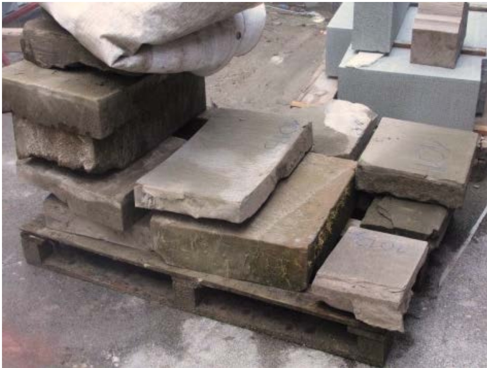
Abb. 1 Projektproben - Ansicht der Ausbauteile der Basilika Weingarten, Westfassade mit Alhydrophobie (Foto S. Schädel).
