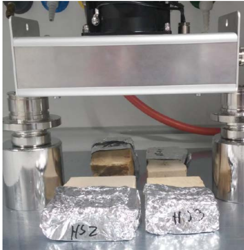
Abb. 17 Versuchsaufbau der Firma UV-EL (Dresden). In dem Aluminiumgehäuse befindet sich die UV-Lampe, in dem darüber liegenden schwarzen Zylinder der Lüfter. Die beiden metallischen Zylinder an den Seiten dienen als Abstandshalter. Die hydrophobierten Sandsteinproben sind jeweils zur Hälfte mit Aluminiumfolie abgedeckt. (Bild und Quelle: Dr. Andreas Meyer und Dipl.-Ing. Rico Schwarzbach, Fa. UV-EL GmbH & Co. KG, Dresden)
