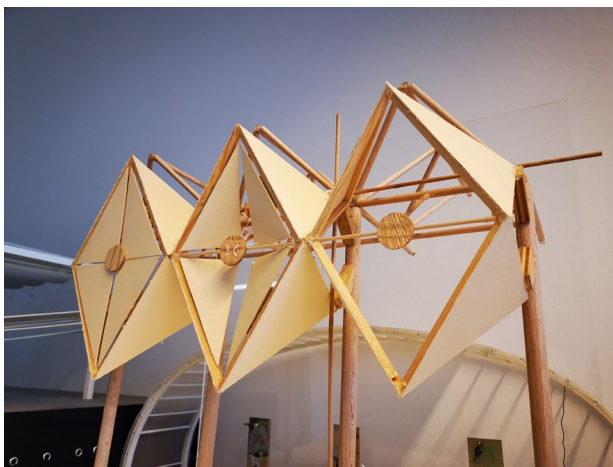
Abb.88: Modell (M1:20) der wandelbaren Dachverschattung in den 3 Zuständen (links) Abb.89: Isometrie Seilzug; Bewegungsablauf eines einzelnen Dreiecks; offen (rechts)
