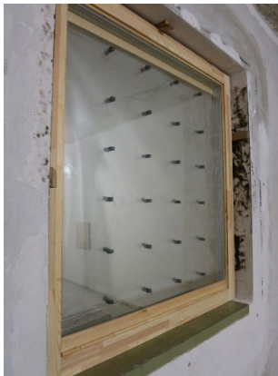
Abb. 22 Foto der „Schallmembran“ im Fensterprüfstand [3] (links)
