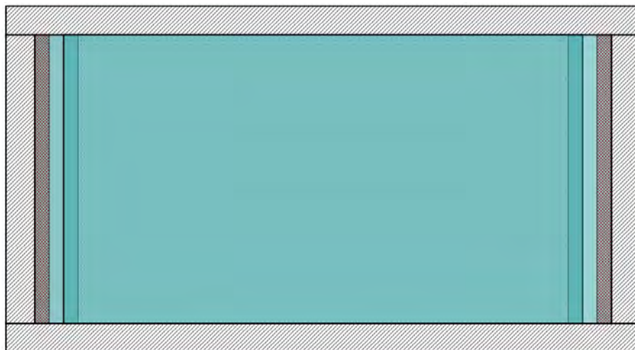
Abbildung 31: Prinzipskizze Variante 3 mit drei mikroperforierten Folien
