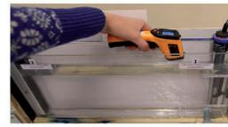
Messe mit dem bereitliegenden Infrarotthermometer die Temperatur des Wassers von oben, wo Klebepunkte aufgebracht sind.
