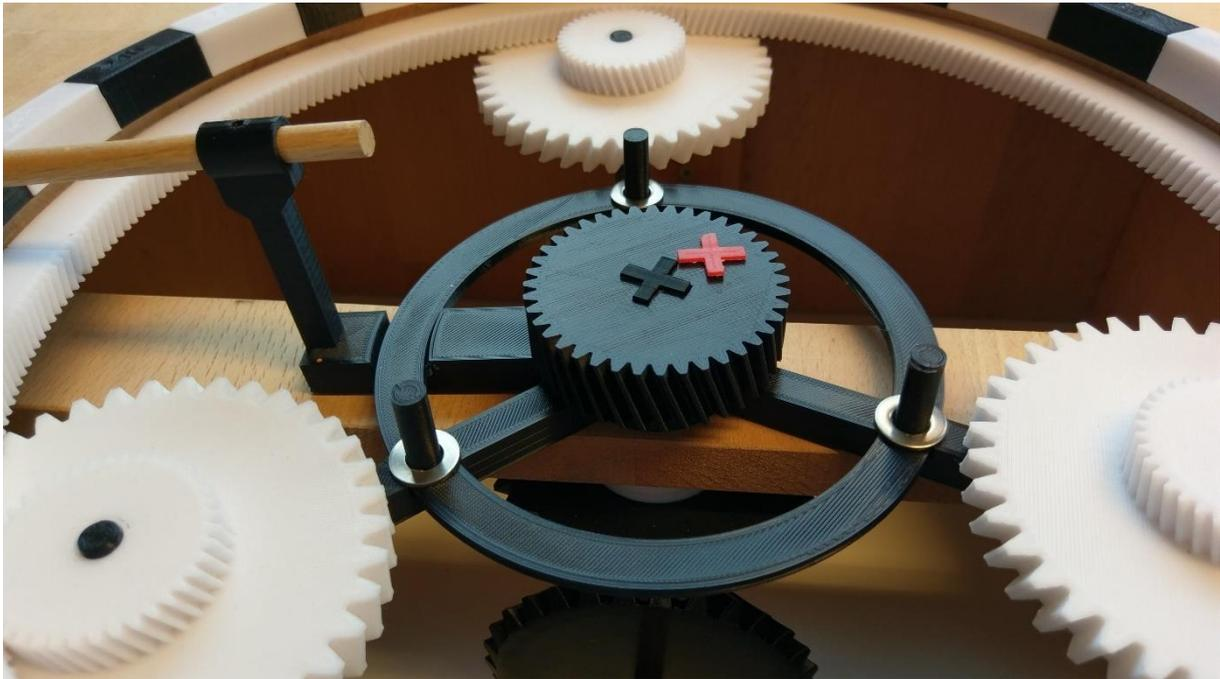
Abb. 36. Zahnradkonstruktion zur Realisierung des nötigen Übersetzungsverhältnisses im Detail
