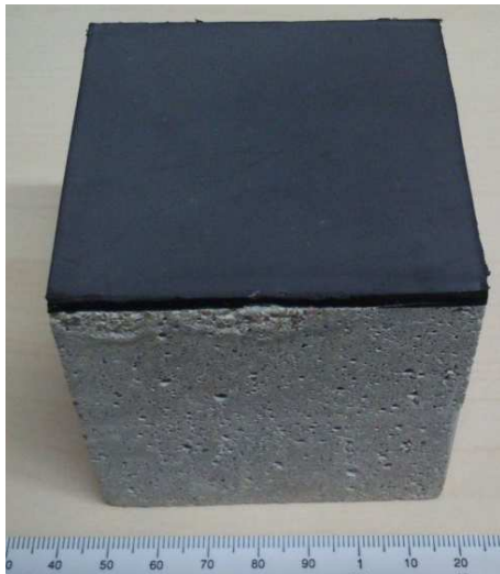
Abbildung 42: Probekörper mit Mantelrohr nach der Prüfung (Schleifmittel Flüssigboden GK4-F0,35-BDAIII (30%))
