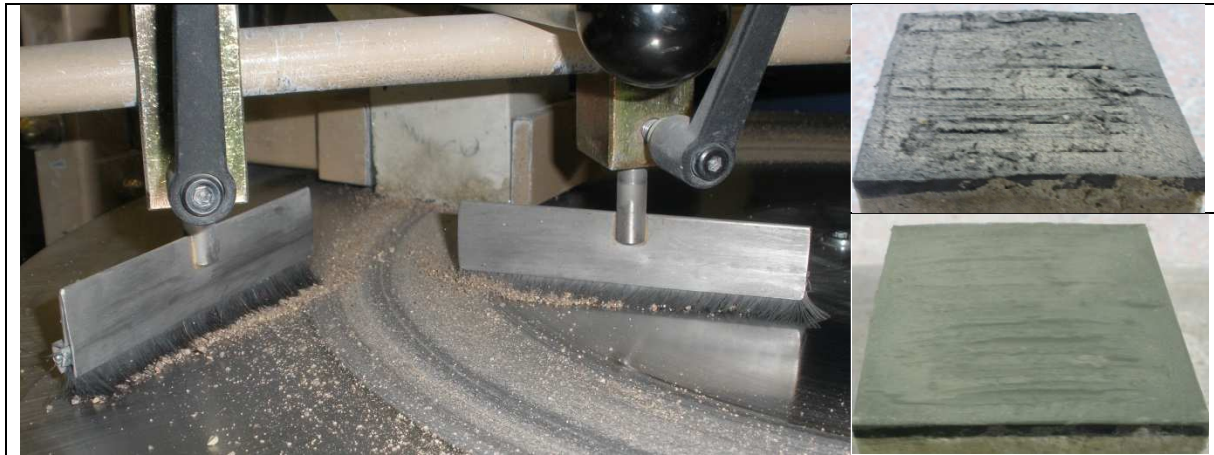
Abbildung 2: Probekörper während der Prüfung (links), Probekörper nach der Prüfung (rechts), Schleifmittel Sand (oben rechts), Schleifmittel Satog (unten rechts)
