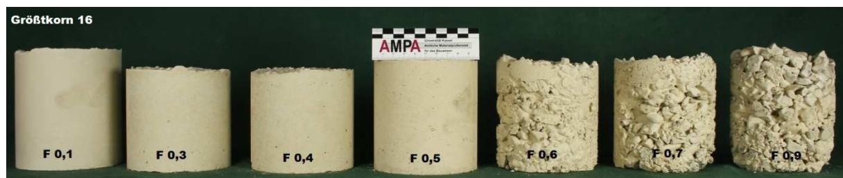
Abbildung 35: Flüssigböden, optimiert mit verschiedenen Fuller-Exponenten [Den14]
