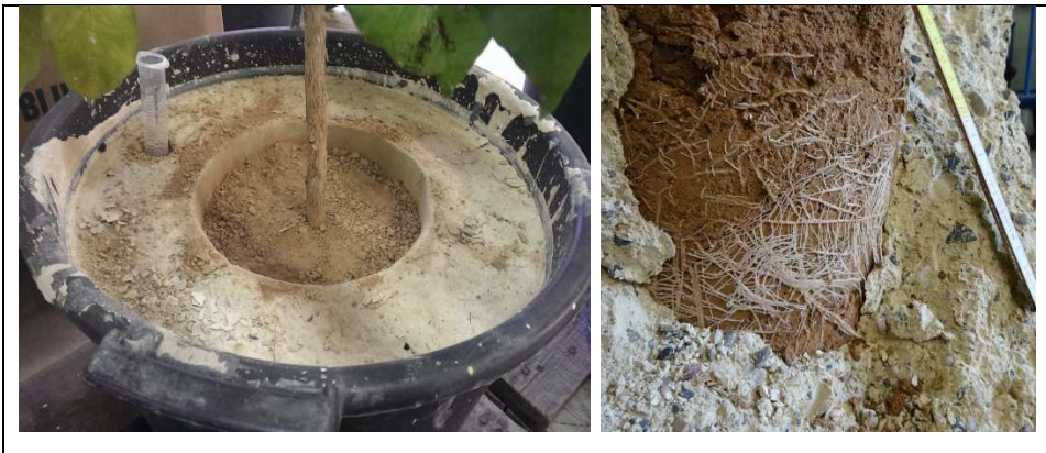
Abbildung 59: (links) Pflanzversuche (Vorversuche) an Kaffeepflanzen (Flüssigboden außen, Lösslehm innen) (rechts) Sichtbarer Blumentopf-Effekt nach dem Aufbrechen des Flüssigbodens nach 32 Wochen.
