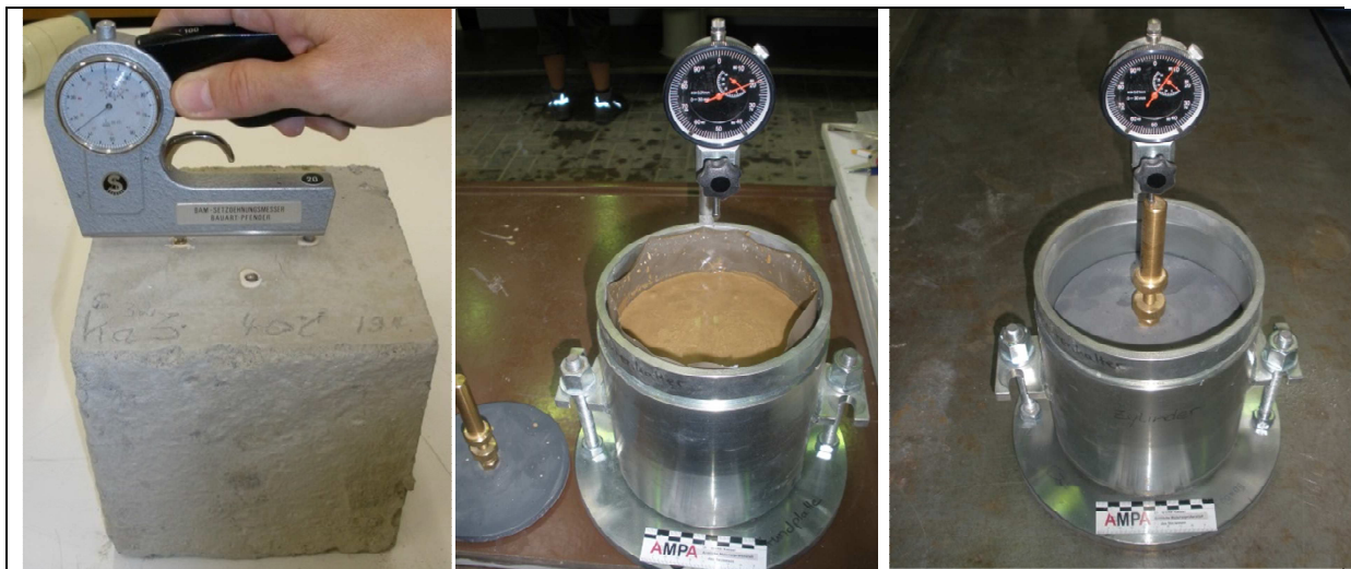
Abbildung 38: BAM-Setzdehnungsmesser (links), CBR-Topf nach dem Befüllen und vor der Prüfung (mitte), CBR-Topf während der Prüfung und ohne Folie (rechts)
