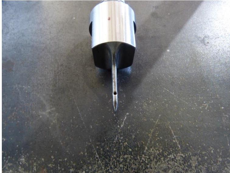
Abbildung 6 In ES 2 eingesetzte Injektionslanze
