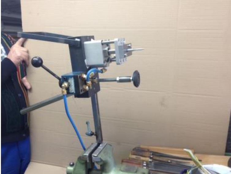
Abbildung 5 Erste Injektionslanze mit hydraulischer Einbringsvorrichtung, Weiterentwicklung des Prototyps
