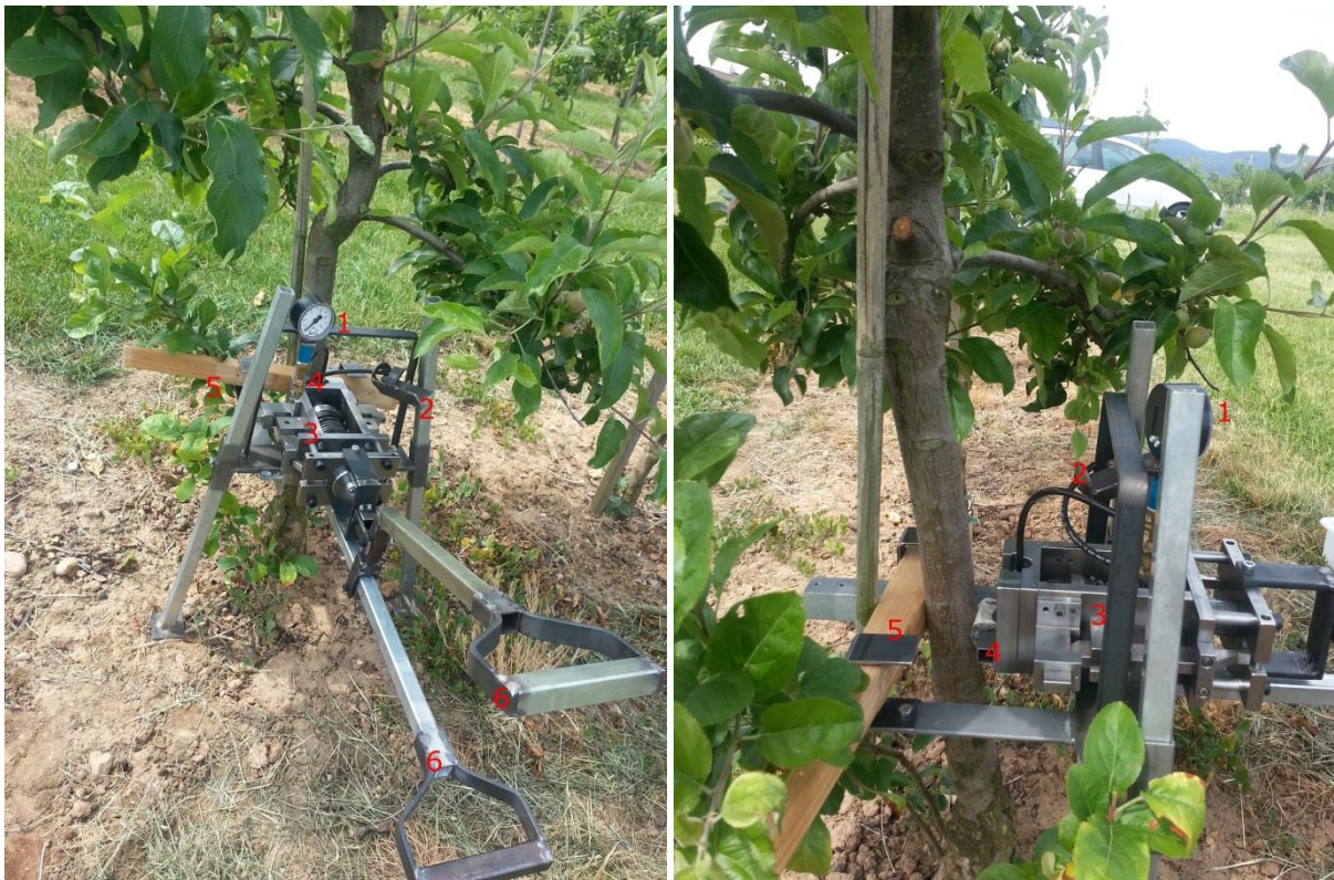
Abbildung 7 ES 2 des Stammapplikators an einem Test-Apfelbaum. Mit den beiden Griffen (6) wird die Stahlfeder (3) vorgespannt und gelöst. Am Manometer (1) kann der Injektionsdruck abgelesen werden, die Spritzenhalterung (2) nimmt die Spritze mit der Applikationslösung auf. Die Injektionslanze (4) wird von der gespannten Feder in den Baumstamm gedrückt. Um ein Rückfedern des Baumstammes zu verhindern, ist dieser mit einem Holzkeil (5) am Applikator fixiert.
