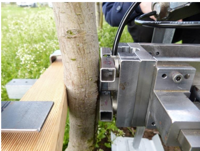
Abbildung 9 Applikationseinheit der ES 4. Neben der neuen Injektionslanze wurden bessere Abstandshalter und Positionierhilfen ober und unterhalb der Lanze angebracht.
