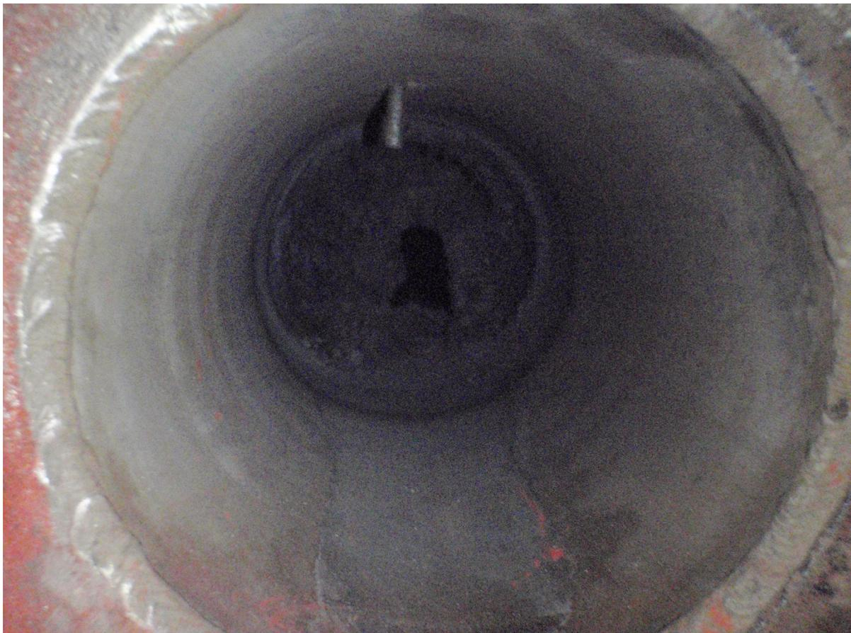
Abbildung 1 Zugesehter Reaktionsraum bei zu hoch gewählter Rohstoffkonzentration.
