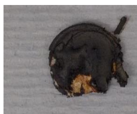
Abbildung 10: Bildung einer Li-Al Legierung
