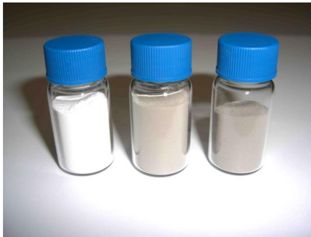
Abbildung 11: reines \text{Li}_2\text{O}_2 Pulver (links), Mn beschichtet (5h) Mitte, Mn beschichtete (10h) rechts
