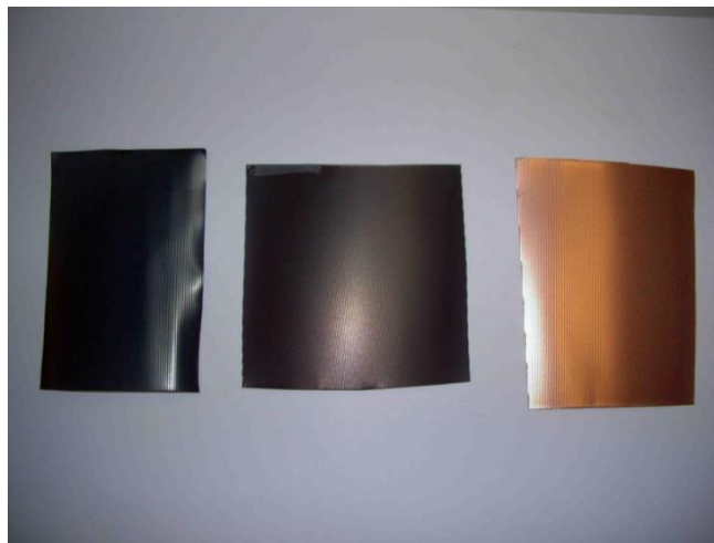
Abbildung 7: Edelstahlfolie (links), ionenstrahlgeätzt (Mitte), kupferbeschichtet (rechts)
