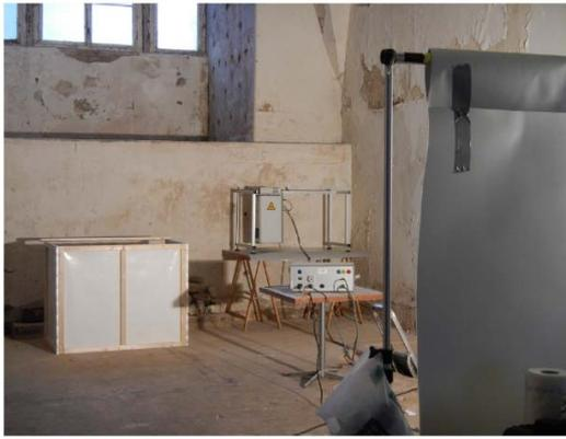
**Abb. 41:** Testfläche und Vorbereitung der Abschirmung für Mikrowellenanwendung
