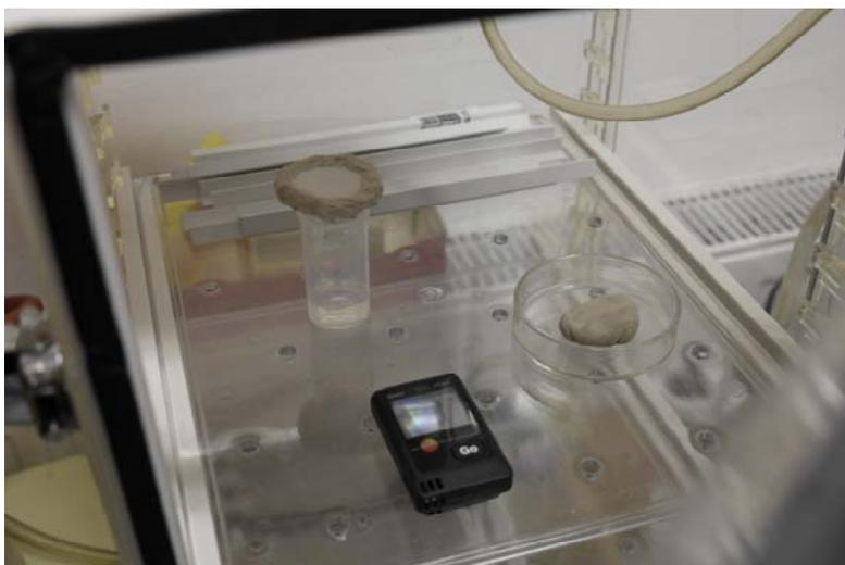
**Abb. 2:** Versuchsanordnung im Klimaschrank zur Bestimmung der Diffusionseigenschaften des Anstriches
