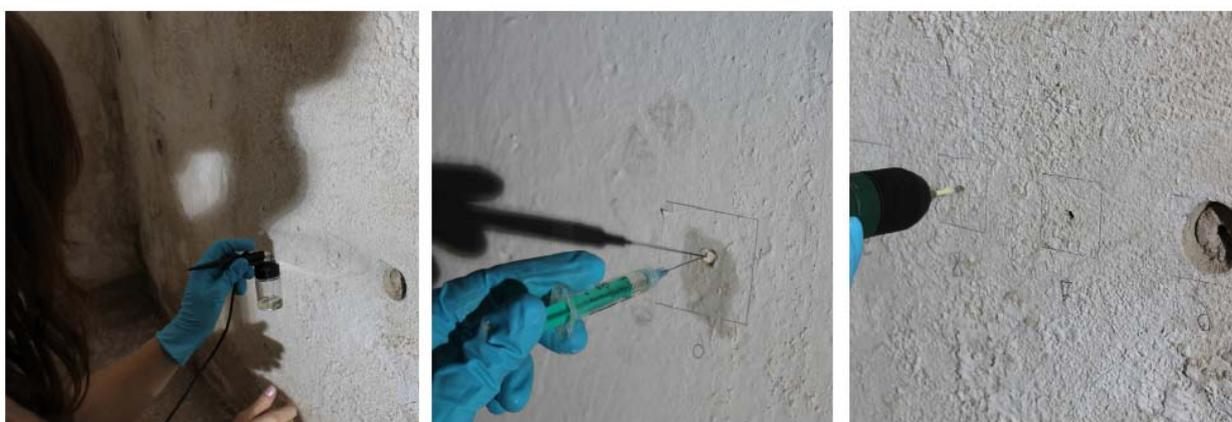
**Abb. 40:** v. l. n. r.: Anlegen der Testflächen durch Aufsprühen und Einspritzen der Keimsuspension, Probennahme nach der jeweiligen Anwendung
