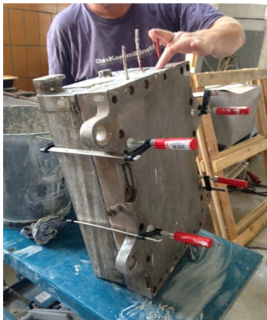
Abbildung 15: mit CSH-Schlicker gefüllte DZ-Form
