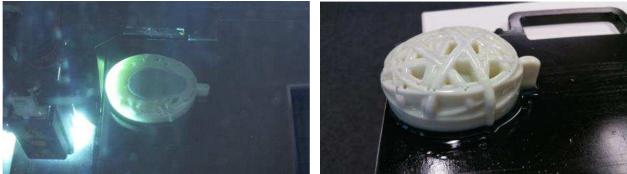
Abbildung 14: Die Kompatibilität zwischen Baumaterial und Support muss geprüft und ggf. angepasst werden. Links sind Abstoßungseffekte erkennbar
