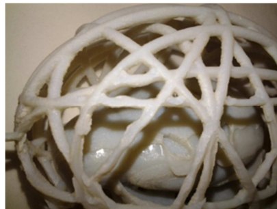
Abbildung 9: Unschärfe der Baumaterialstruktur durch schlecht stabilisierenden Support
