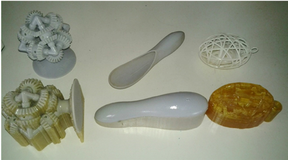
Abbildung 1: untere Reihe: gedruckte Bauteile nach dem Druckvorgang, aber noch vor der Supportentfernung; obere Reihe: Bauteile nach der Entfernung des Supportmaterials (Bauteil oben rechts © purmundus)
