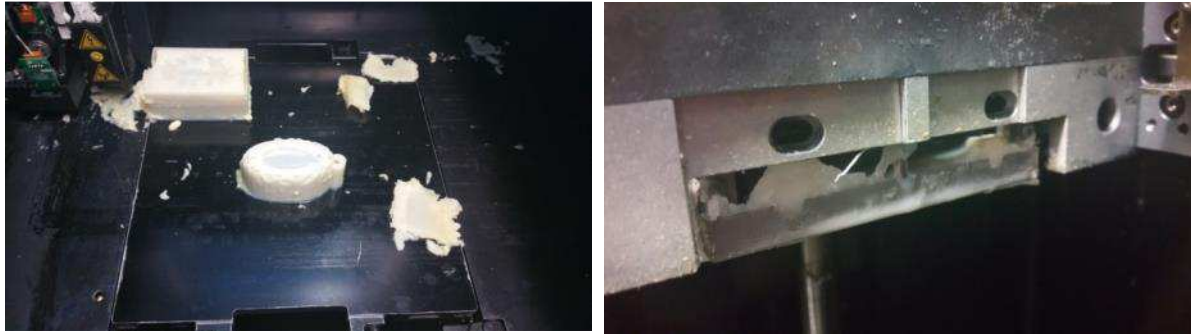
Abbildung 12: rechts ist der Roller bzw. die dem Roller zugehörige Rakel und Abfuhrsystem durch zu klebriges Supportmaterial verklebt; links ist das dadurch resultierende Verschmutzen im Druckraum zu erkennen
