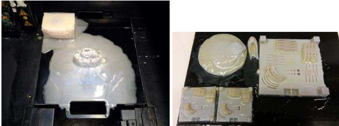
Abbildung 8: Beispiele für Ausschwitzen und/oder Schmelzen eines Supportes bzw. zu geringe Stabilität des Gitters bzw. des Supportmaterials
