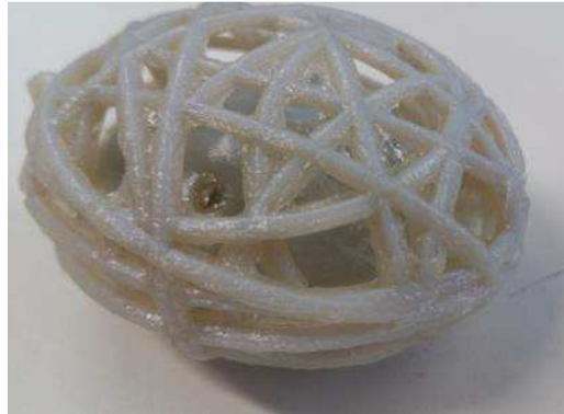
Abbildung 16: Nach der Trocknung verbleiben Supportreste am Baumaterial
