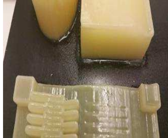
Abbildung 14: DBU04-15, High Speed breitflächiger, deutlicher Overspray, schlechtestes Ergebnis, deutliche Fehlstellen/Rillen
