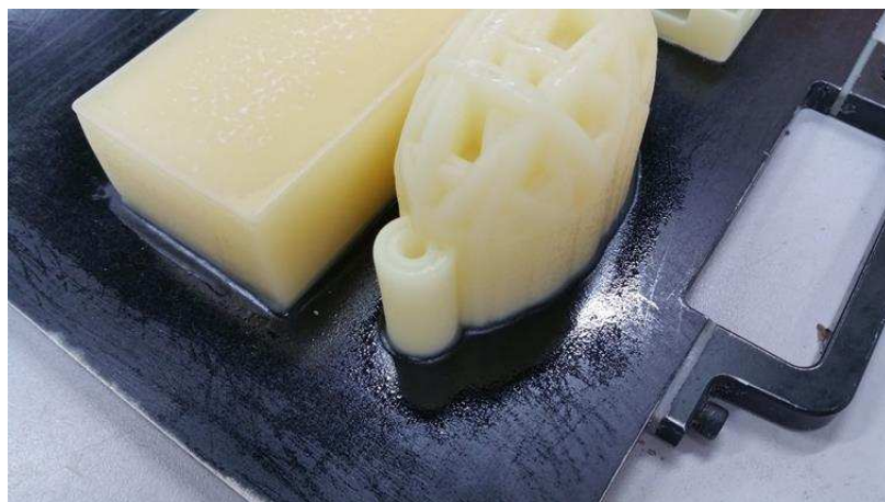
Abbildung 12: deutlich sichtbarer Overspray um die Bauteile
