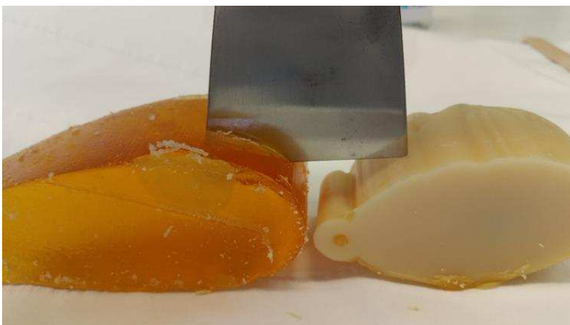
Abbildung 10: Vergleich verschiedener Supports (links: bröseliger Support, der mechanisch entfernt werden kann und NaOH-löslich ist (Stand der Technik); rechts: wasserlöslicher Support, der sich ausschließlich durch die Lösung in Wasser entfernen lässt)
