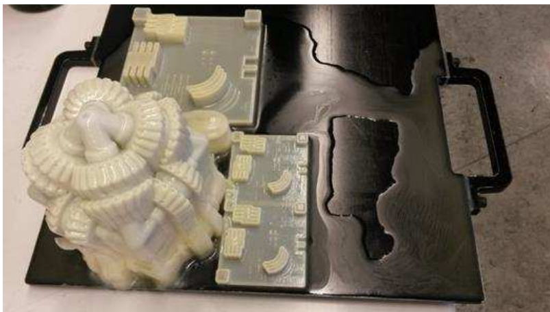
Abbildung 7: Verschmutzung der Druckplattform durch zu wenig aushärtendes Supportmaterial
