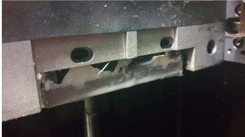
Abbildung 9: Verkleben von Anlagenkomponenten bei zu geringem Vernetzungsgrad
