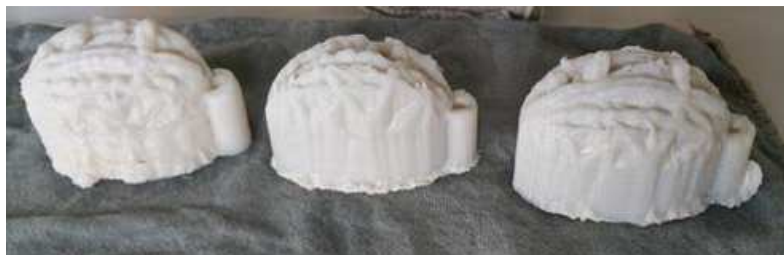
Abbildung 17: verschiedene Gitterstrukturen aus Baumaterial innerhalb des wasserlöslichen Supportes NACH dem Wasserbad
