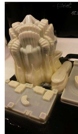
Abbildung 8: unzureichende Stabilisierung durch zu weichen Support
