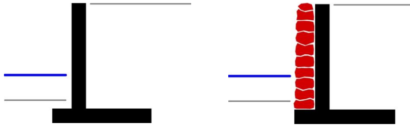
Abb. 17: Konstruktionsformen von Winkelstützwänden
