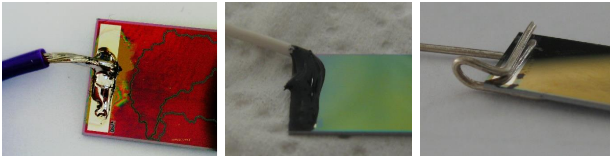
Abbildung 6: Kontaktierungen: Löten, kleben, klemmen
