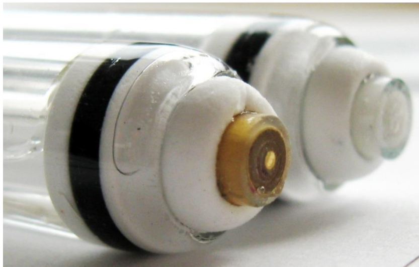
Abbildung 1: Sensor mit Mikroelektrode, ein Draht Durchmesser 1.000 µm
