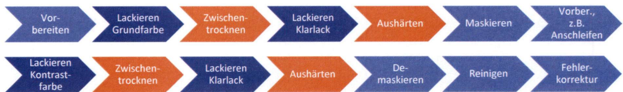
Abbildung 1: Prozessablauf bei Mehrfarbenlackierung mit Maskierung (Ist-Zustand) – orange: Trocknungsprozesse, dunkelblau: Lackierprozesse, hellblau: manuelle Operationen
