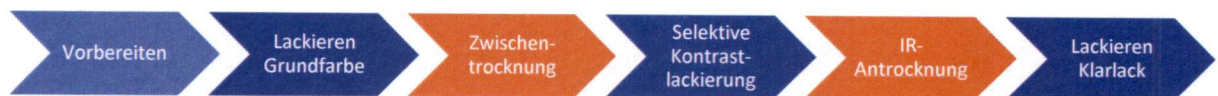
Abbildung 2: Prozessablauf bei maskierungsfreier Mehrfarbenlackierung (Projektziel) – orange: Trocknungsprozesse, dunkelblau: Lackierprozesse, hellblau: manuelle Operationen
