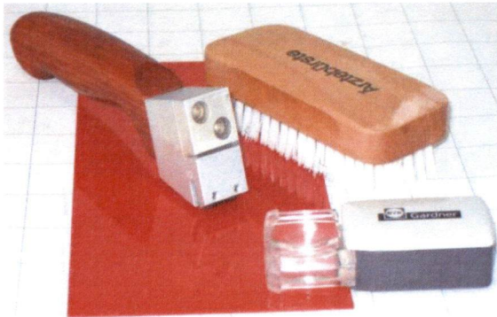
Abbildung 26: Verwendete Methodik zur Prüfung der Lackhaftung (Gitterschnitt)
