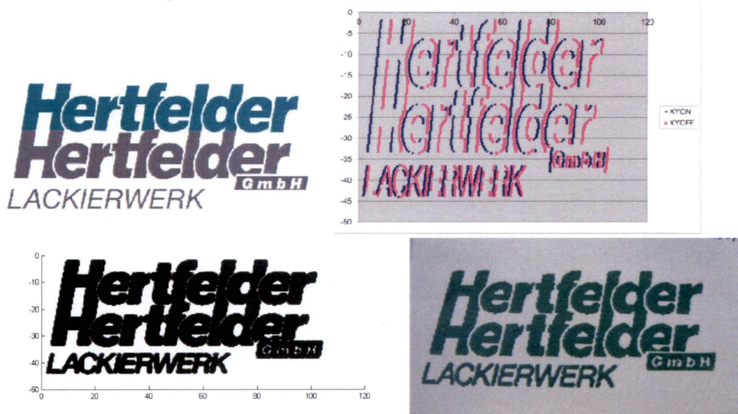
Abbildung 27: Umwandlung Prozedur des Bildes: Vom Logo als pdf zu einer Berechnung der Ein- und Ausschaltzeit zur Simulation und schließlich der Applikation mit Lack.
