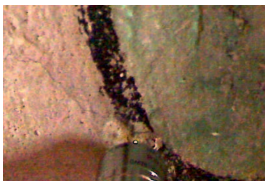
Abb. 10: Dokumentationsfoto der mobilen Ramansonde MoRaS am Messpunkt R10 in der Sakristei der Klosterkirche in Angermünde. Der helle Punkt direkt vor dem Mikroobjektiv markiert die genaue Messposition für das registrierte Ramanspektrum.
