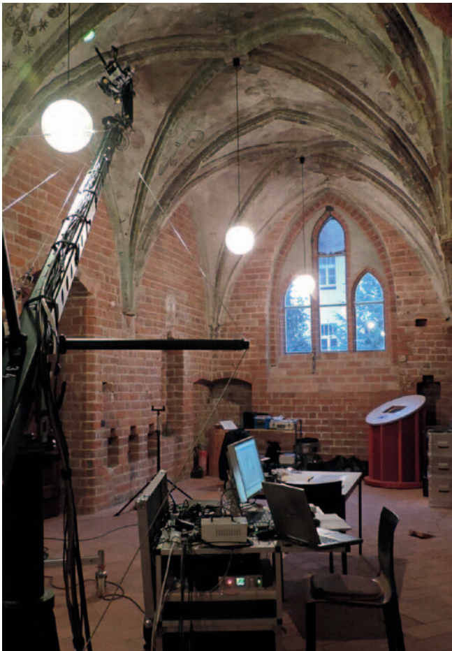
Abb. 4 Die mobile Ramansonde MoRaS bei Messungen in der Sakristei der ehemaligen Franziskaner-Klosterkirche in Angermünde in ca. 4,5 m Höhe, Foto: Martin Ziemann, 2015
