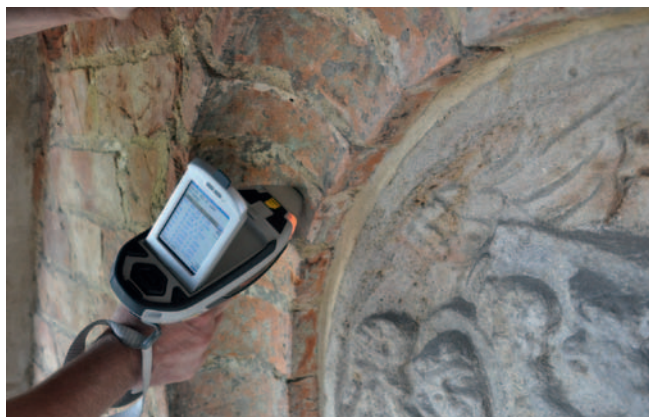
Abb. 3: Einsatz der portablen RFA an einem bemalten Ziegel, Frankfurt (Oder), Marienkirche, Nordportal, Foto: Ute Joksch, 2016
