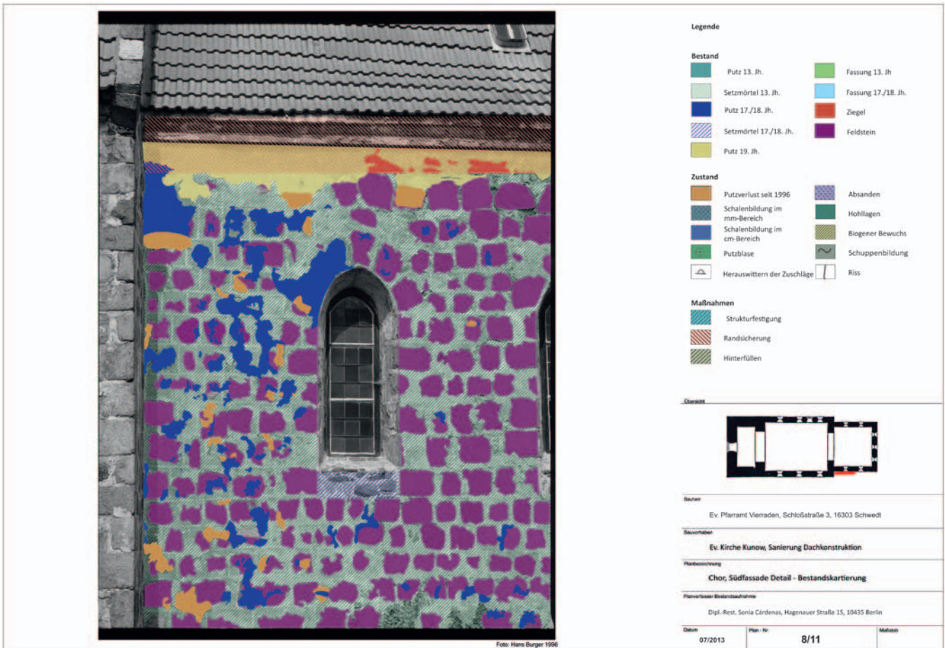
Abb. 21: Dorfkirche Kunow, Chor Detail der Südfassade, Bestandskartierung, Kartierung Sonia Cárdenas 2013 auf der Grundlage eines Detailfotos von 1996
