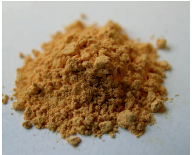
Abb. 6: Vanadinit aufbereitet als Pigment mit kräftig gelber Farbe, 0 - 120 \mu m (#10840, Kremer-Pigmente GmbH & Co KG, Aichstetten), Foto: Martin Ziemann
