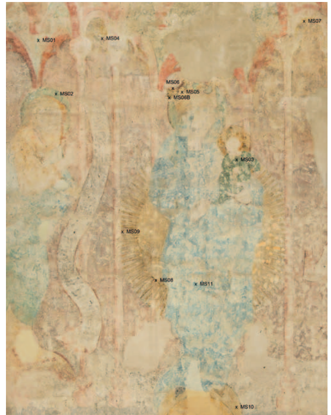
Abb. 4: Frankfurt (Oder), Marienkirche, Mondsichelmadonna, Lokalisierung der Messpunkte bzw. der Probeentnahmestellen (RFA, REM/EDX)
