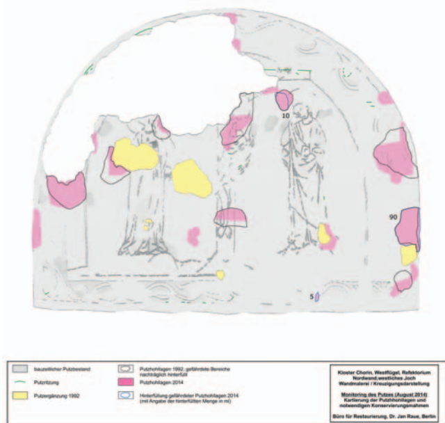
Abb. 2: Chorin, Refektorium, Nordwand, Kreuzigung, Kartierung der Putzhohllagen und Nachkonservierung der Putze, August 2014
