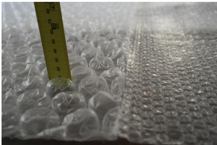
Abbildung 64. Die beiden Varianten der eingesetzten PE-Folie.
