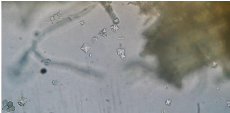
Abbildung 60. Tesafilmprobe: Oktaederförmige Kristalle, keine Doppelbrechung Probe 1, Günserode) (Vergrößerung 400x).
