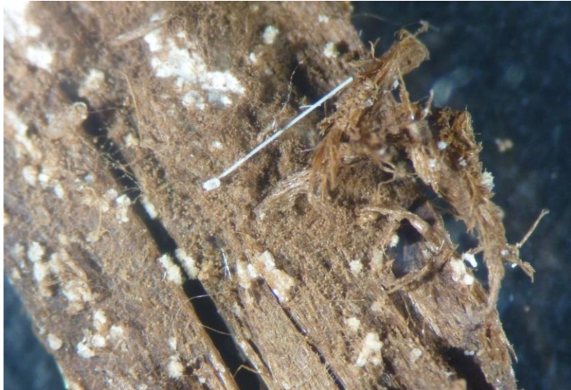
Abbildung 51. Mazeriertes Holz mit weißen Salzkristallen, die entweder aus einer Flammenschutzbehandlung oder dem Urin der Fledermäuse stammen. Weiterhin sind Pilzhypen (fädige Struktur) zu erkennen (Probe 1, Kirche Günserode; Vergrößerung 16x).
