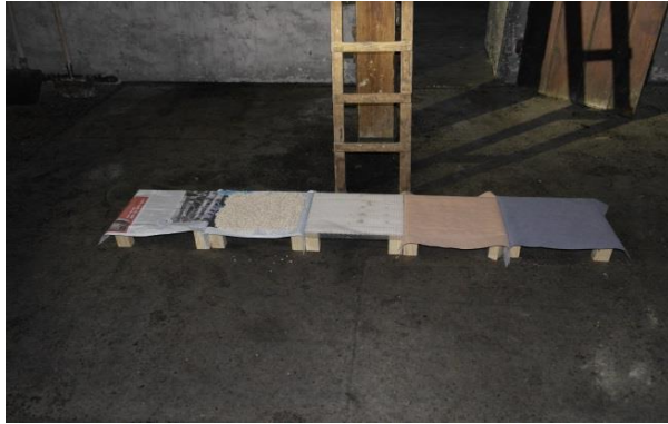
Abbildung 82. Musterflächen unterhalb des Hangplatzes – Bretter belegt mit den folgenden Materialien: Zeitung / Zeitung mit einer Auflage von Katzenstreu / Luftpolyesterfolie / orange Unterspannbahn / graue Unterspannbahn (UDB210).
