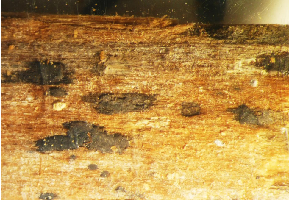
Abbildung 46. Holz aus dem Dachstuhl mit schwarzen Punkten unter Auflichtmikroskop - Flecken folgen der Holzmaserung (Vergrößerung x 20; Probe 5, Günserode).
