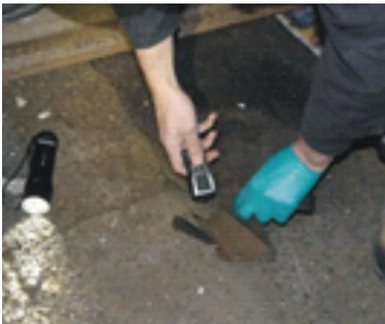
Abbildung 36. Messung der Holzfeuchte mit dem Leitfähigkeitsverfahren mit kompaktem Holzfeuchtemessgerät.
