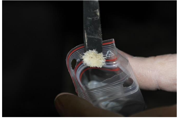
Abbildung 58 A und B. Salzkristalle aus dem Dachstuhl der Kirche in Günserode: Kristalle unter dem Mikroskop auf mazeriertem Holz (A; Vergrößerung 50x; links); Kristall vom Fußboden, unterhalb der diffusionsdichten Schutzfolie, wie er in ein Probentütchen abgefüllt wurde (B; links).
