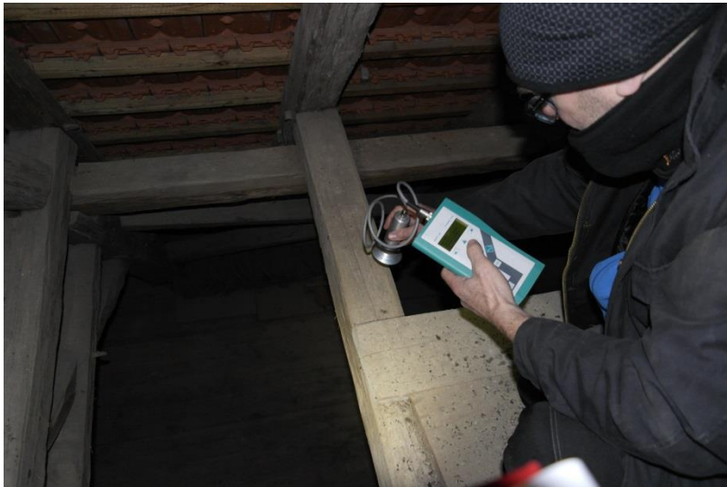
Abbildung 37. Messung der Holzfeuchte mit dem Mikrowellenverfahren.
