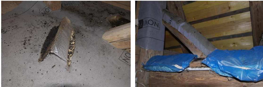
Abbildung 74. Drahtkonstruktion nach Beaufschlagung (links), nach Austausch von Folie und Katzenstreu (rechts).
