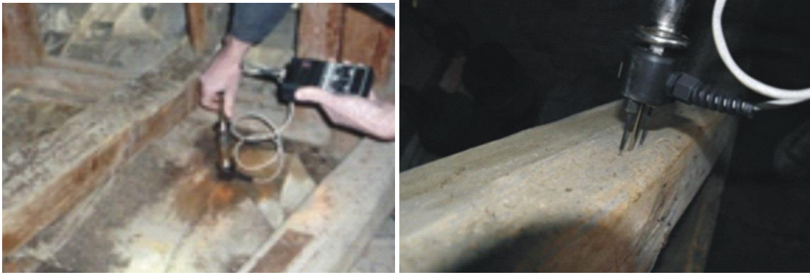
Abbildung 35 A und B. Messung der Holzfeuchte mit dem Leitfähigkeitsverfahren.
