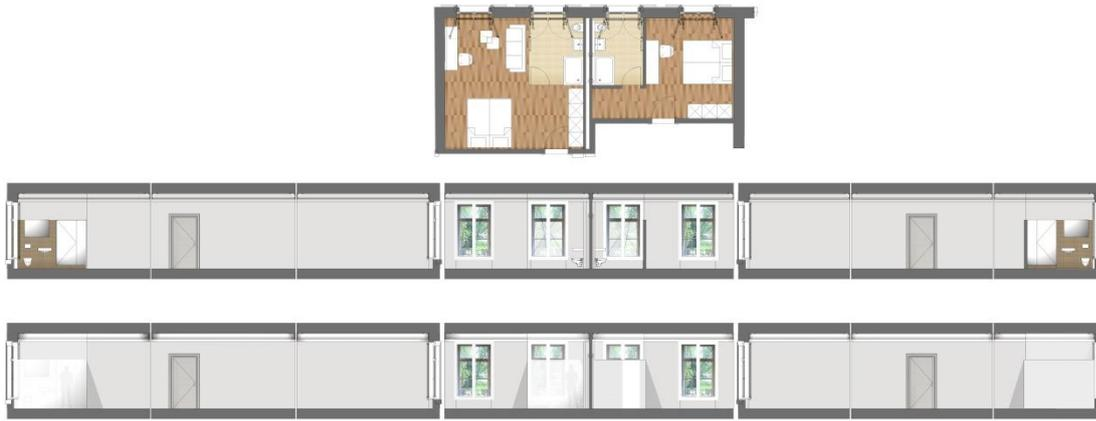
Abb. 19: Wandabwicklung der an der Außenwand angeordneten Badzellen, Architekten Keß und König
