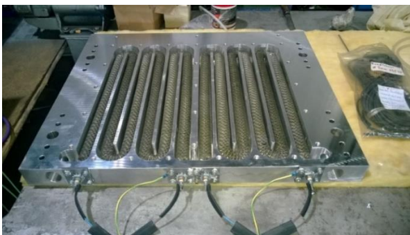
Prototyp Hauptmodul mit Rippenrohrheizelementen Bild 5.7.6
