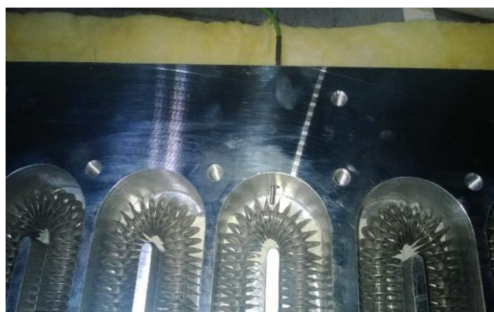
Hauptmodul mit Umlenkung des gefrästen Strömungskanals
