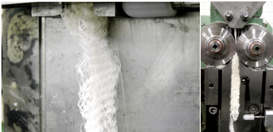
Abbildung 6: Gecrimpte Faser zu wenig Crimp linke; gecrimpte Faser gestaucht
