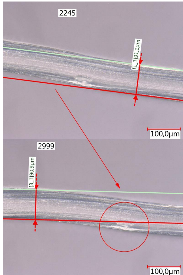
Abbildung 7: Faser aus der Laboranlage 2999 in Bremen und aktuelle Qmilch Faser 2245
