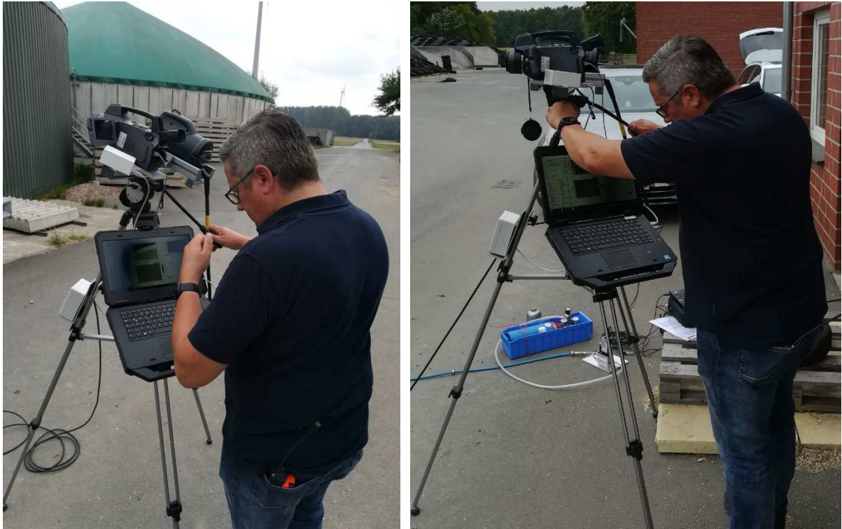
Abbildung 4.2: Erprobung des Messsystems unter Praxisbedingungen durch einen Gasspürer.
